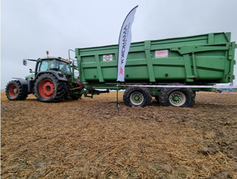
Als Kontaktpunkt zum Boden stützen die Reifen das Gewicht des Fahrzeugs ab und setzen die Motorleistung in Traktion und Vortrieb um. Je nach Aufstandsfläche, Reifendruck und Profil kann jedoch Schlupf die Traktion vermindern und der Boden verdichtet werden. Um nachteilige Auswirkungen weitgehend zu vermeiden, gibt es eine einfache Regel: Je größer die Aufstandsfläche und je niedriger der Reifeninnendruck, desto geringer das Risiko von Bodenschäden.
