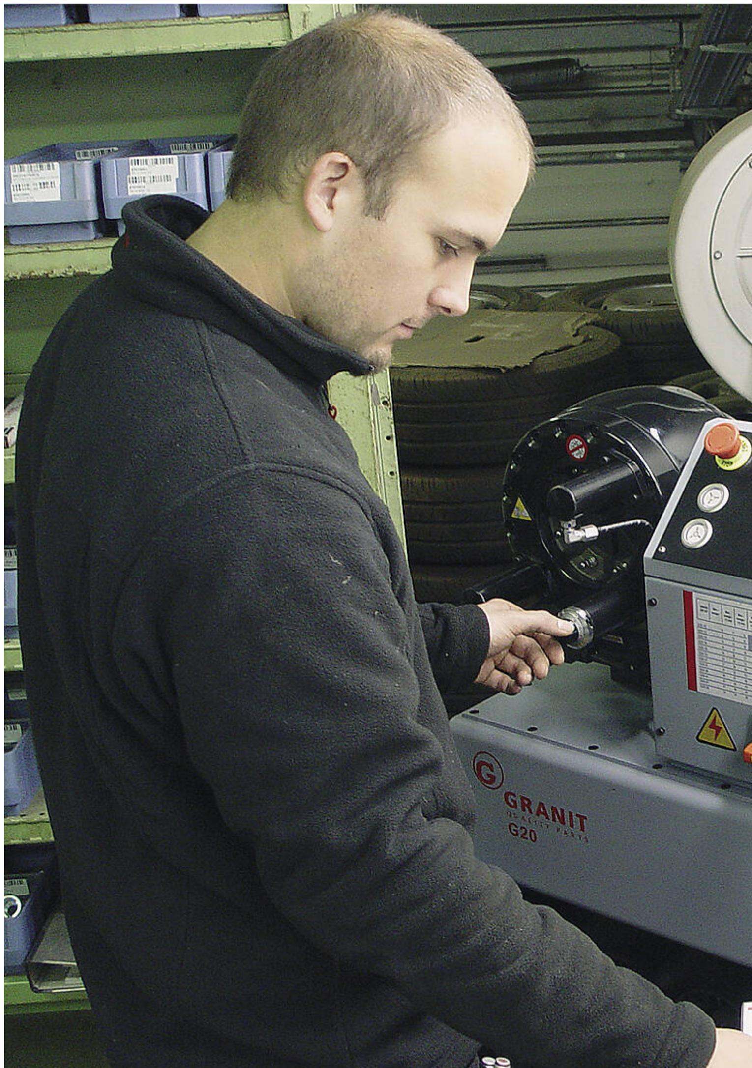
Die stufenlose, exakte Einstellung des Pressmaßes wird an der Mikrometerschraube vorgenommen, die entsprechenden Werte entnimmt man der Granit-Pressmaßtabelle.
