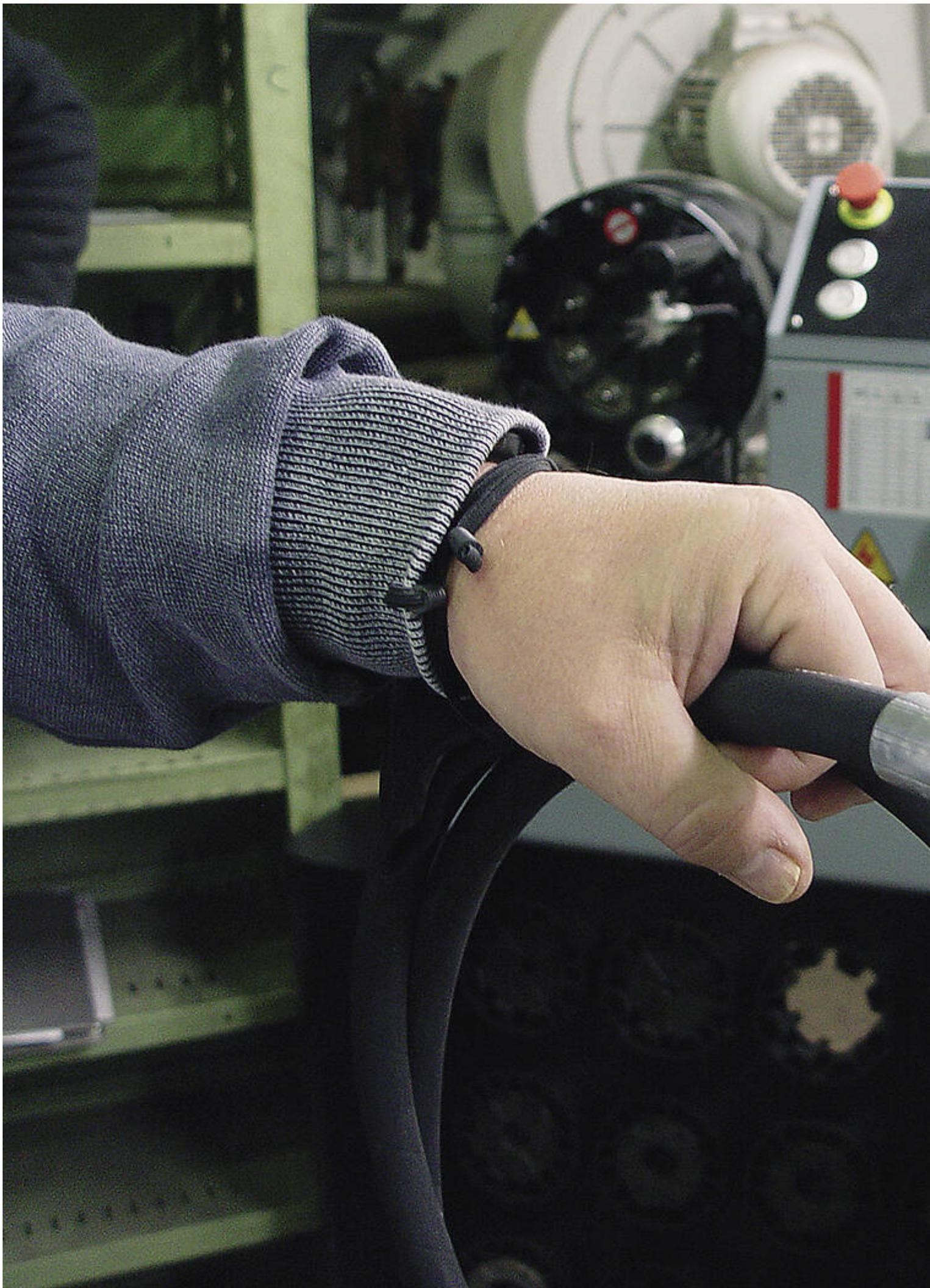
Der letzte Handgriff: die Kontrolle. Abschließend überprüft Sascha Brünjes mit dem Prüfdorn den Nippel einfall.
