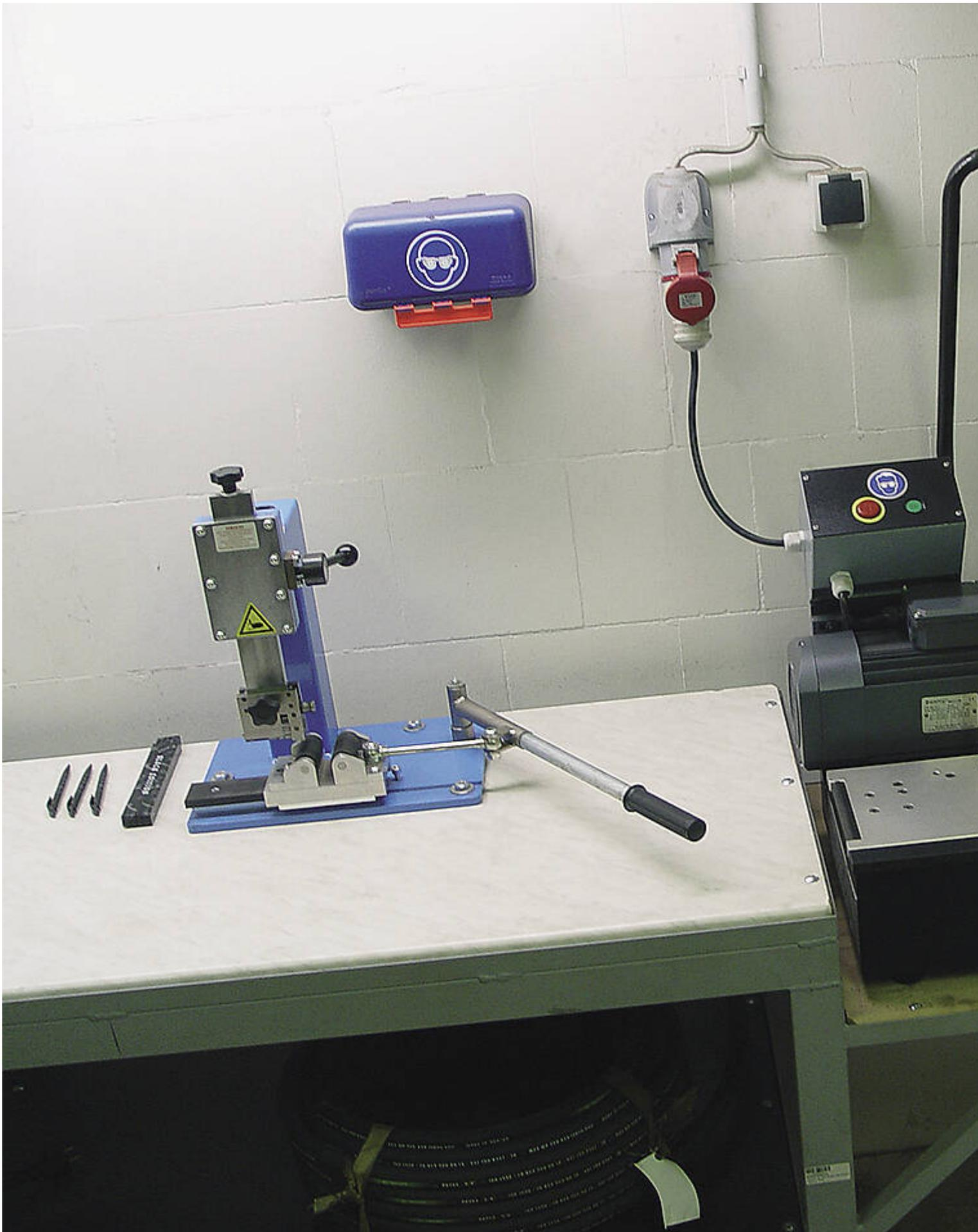
Mit dem Granit Prägegerät Smart (links) lassen sich die Pressfassungen einfach und eindeutig kennzeichnen. Ebenso einfach und eindeutig lassen sich die Pressfassungen von 4 SH/R13-R15 bis Din 50.
