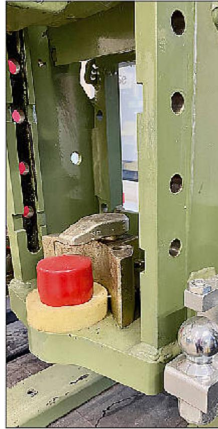
Anhängebock mit genormten Befestigungspunkten für Zwangslenkung.
