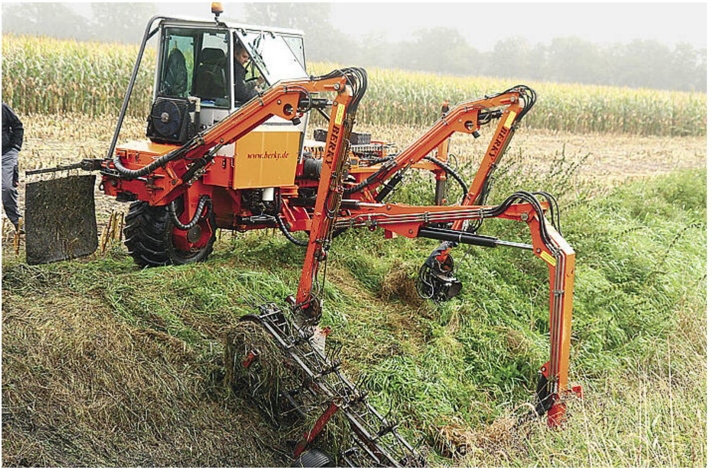
Der Böschungsmäher 2200 von Berky ist ein Dreirad mit einem Stützradausleger.
