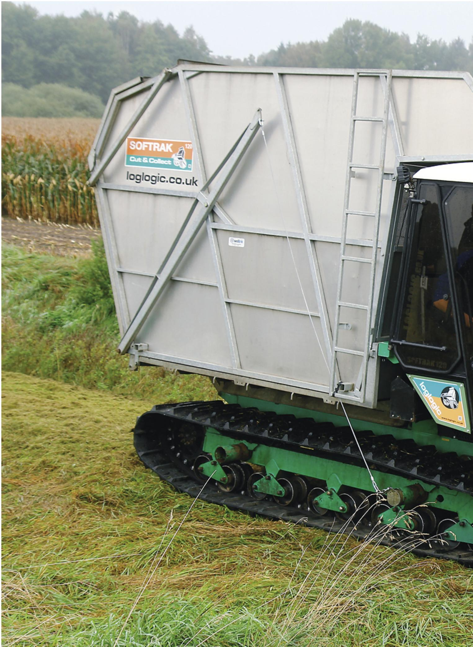
Der Softrak von Loglogic transportiert das abgemähte Gut in einer Kippmulde.
