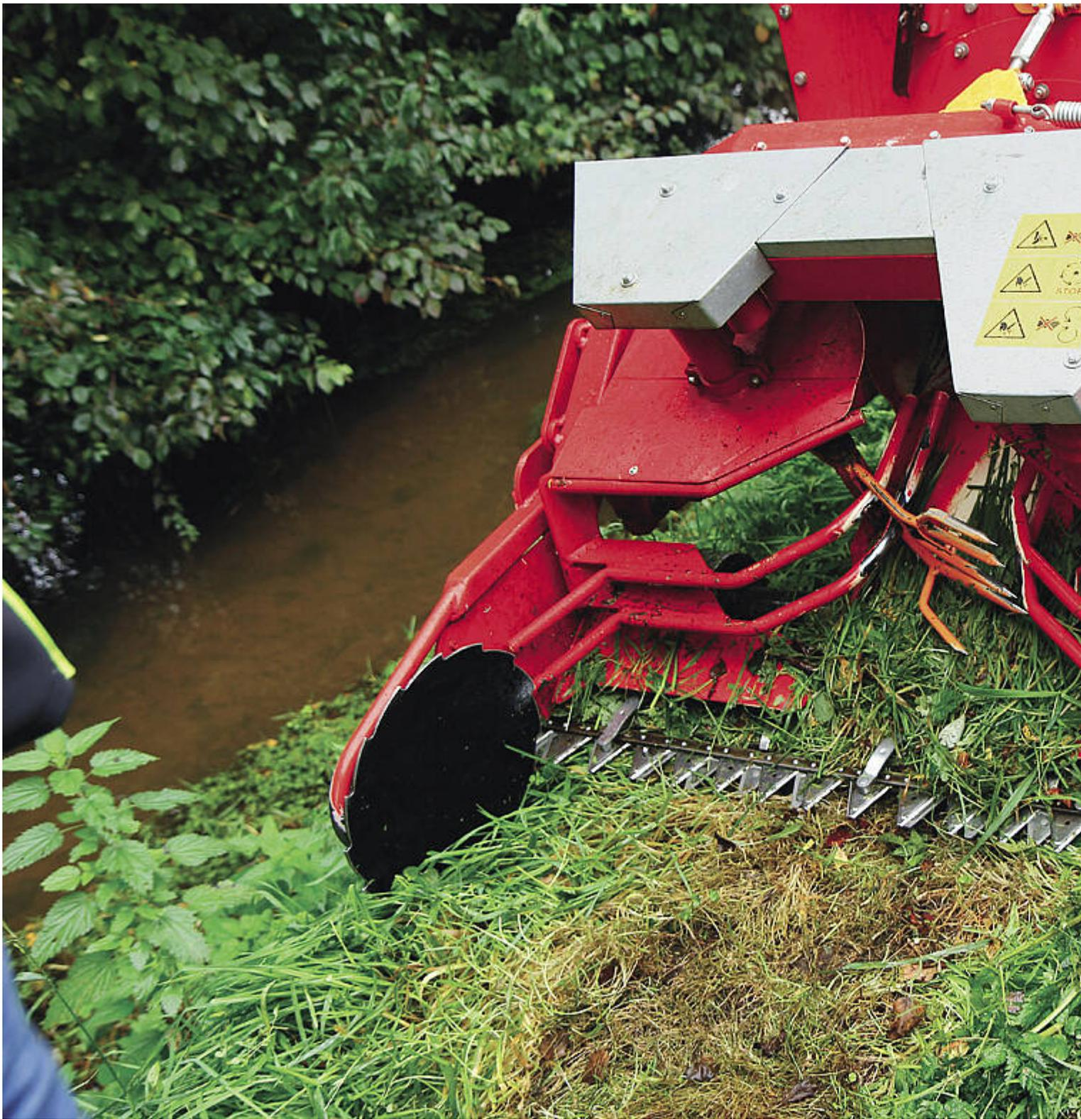
Beim DUA 800 von Dücker wird das Mähgut über einen Schlauch in den Anhänger gefördert.
