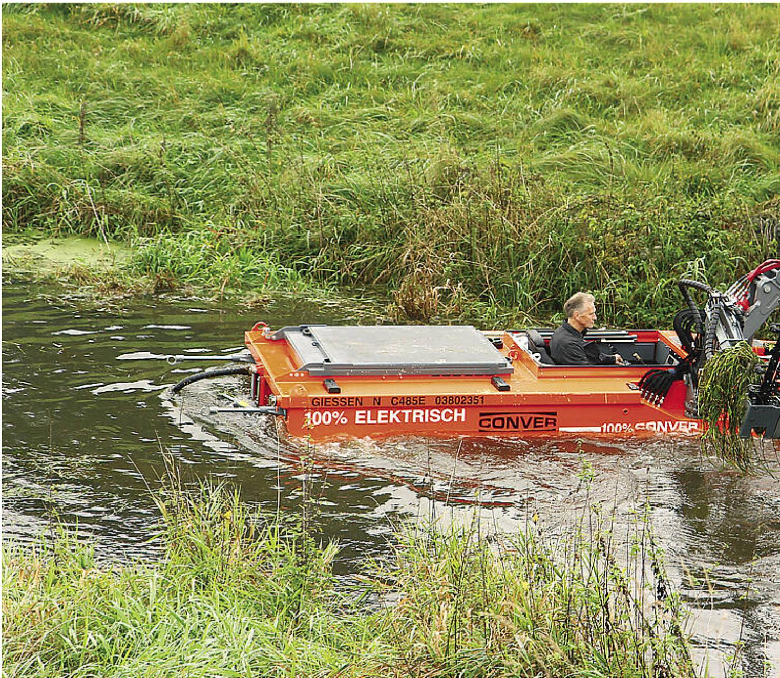
Das Mähboot C485 von Conver arbeitet mit Elektroantrieb.
