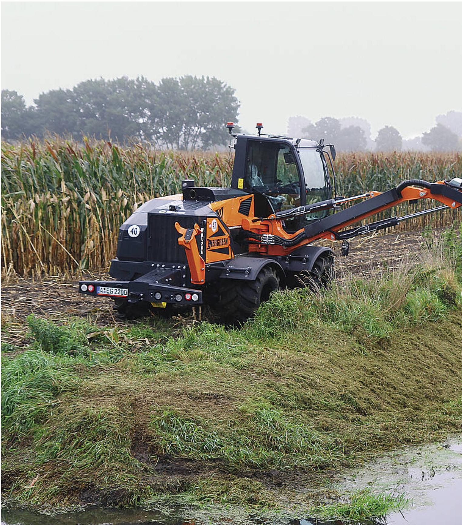
Beim Geräteträger ILF Alpha T10 von energreen lässt sich die Kabine um 90 Grad drehen.
