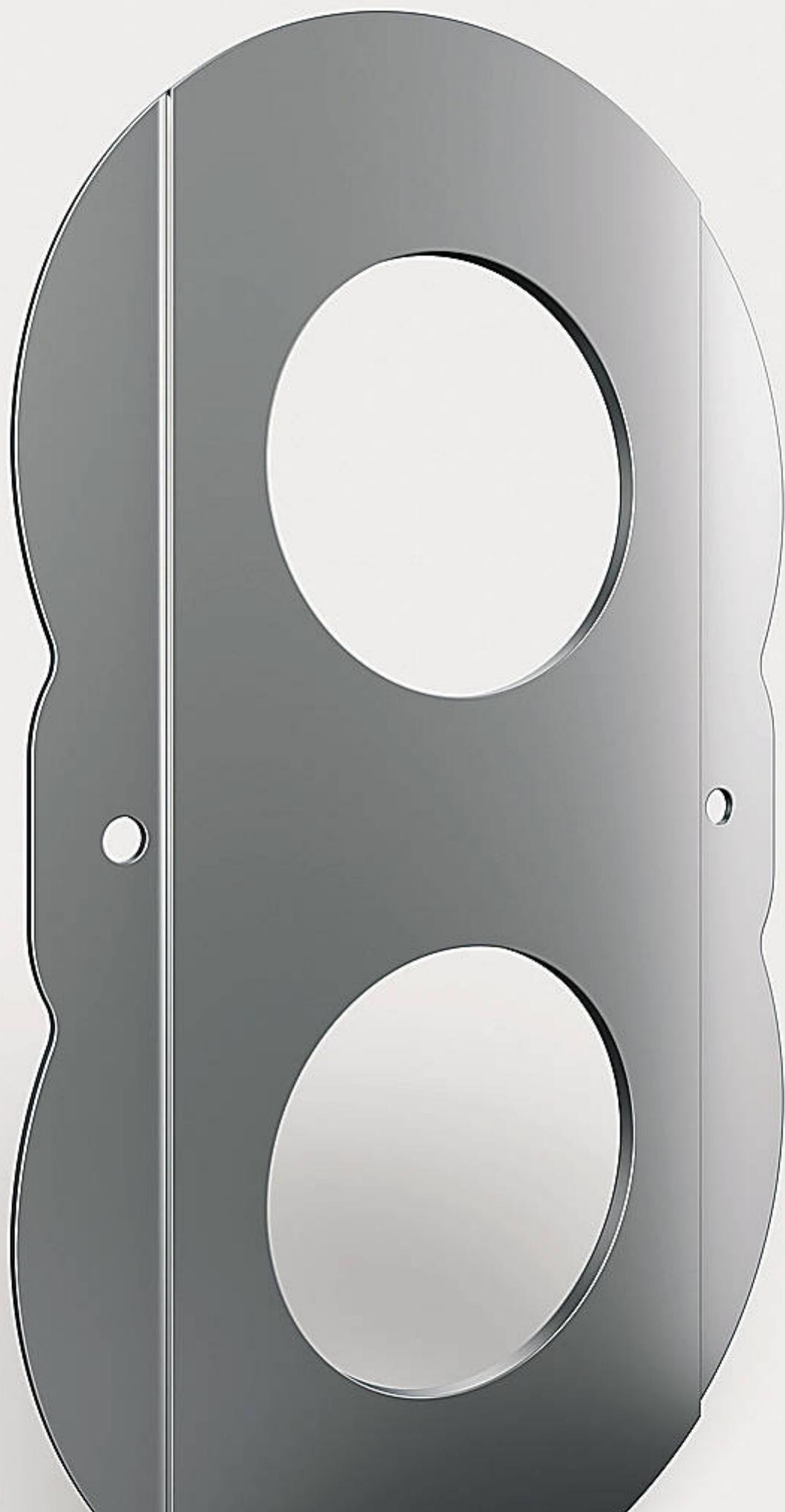
Pumpentechnik: Die modifizierte Schutzplatte hält Faserstoffe von der Dichtung fern. Dadurch lässt sich die Standzeit der Dichtung um das Vierfache erhöhen.
