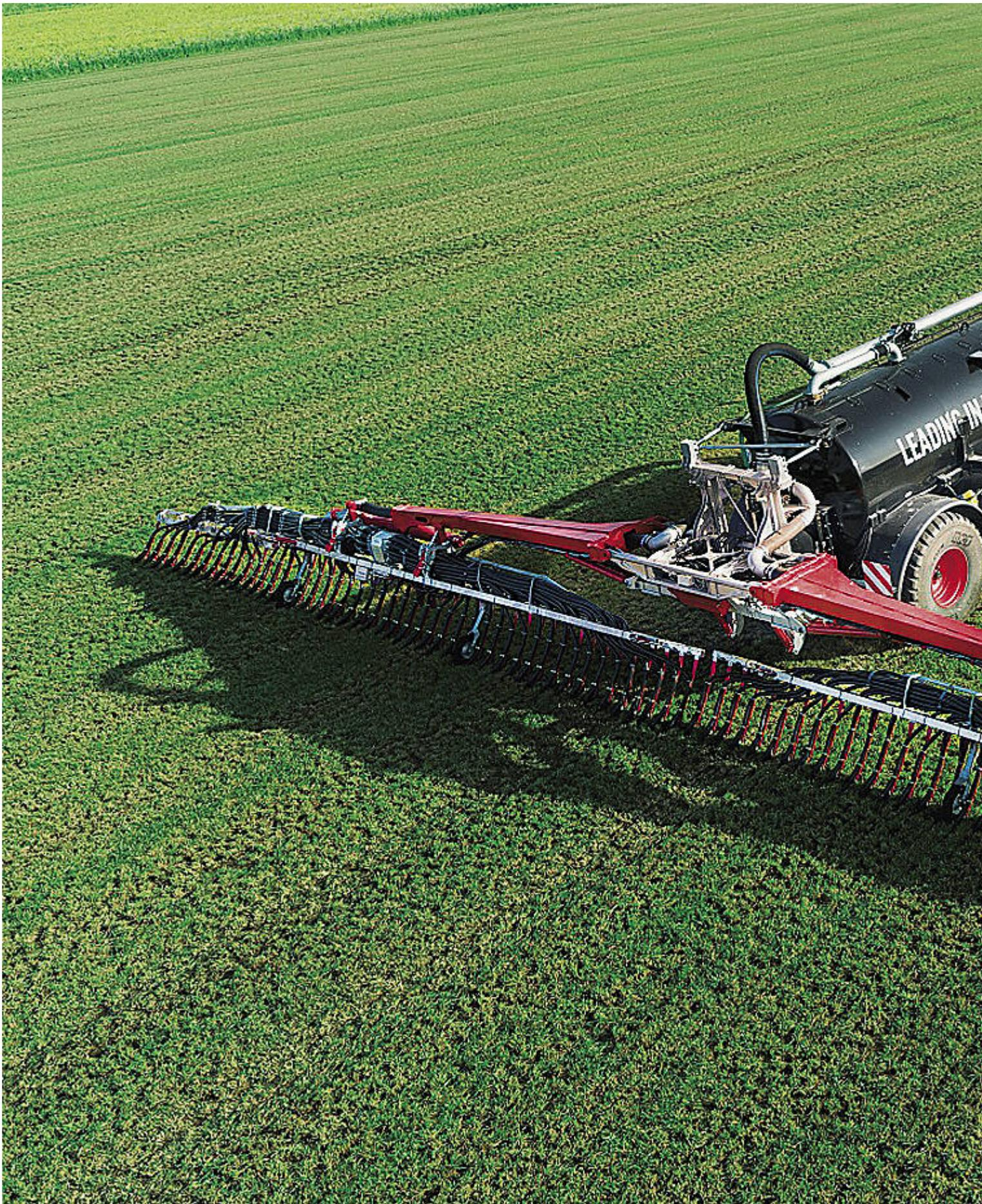
Auf 24 Metern Arbeitsbreite platziert das BlackBird Schleppschuhgestänge die Gülle präzise an der Pflanze.
