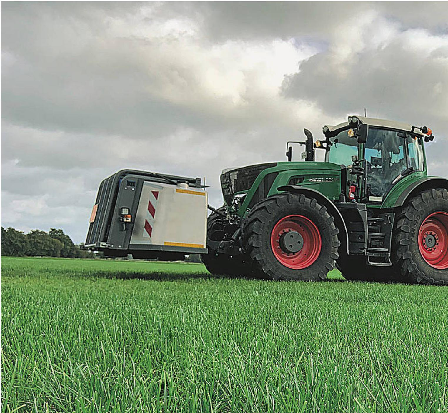
SyreN ist ein geschlossenes System, das die Gülle stabilisiert und Stickstoffverluste reduziert. Die zugesetzte Schwefelsäure wird dosiert.
