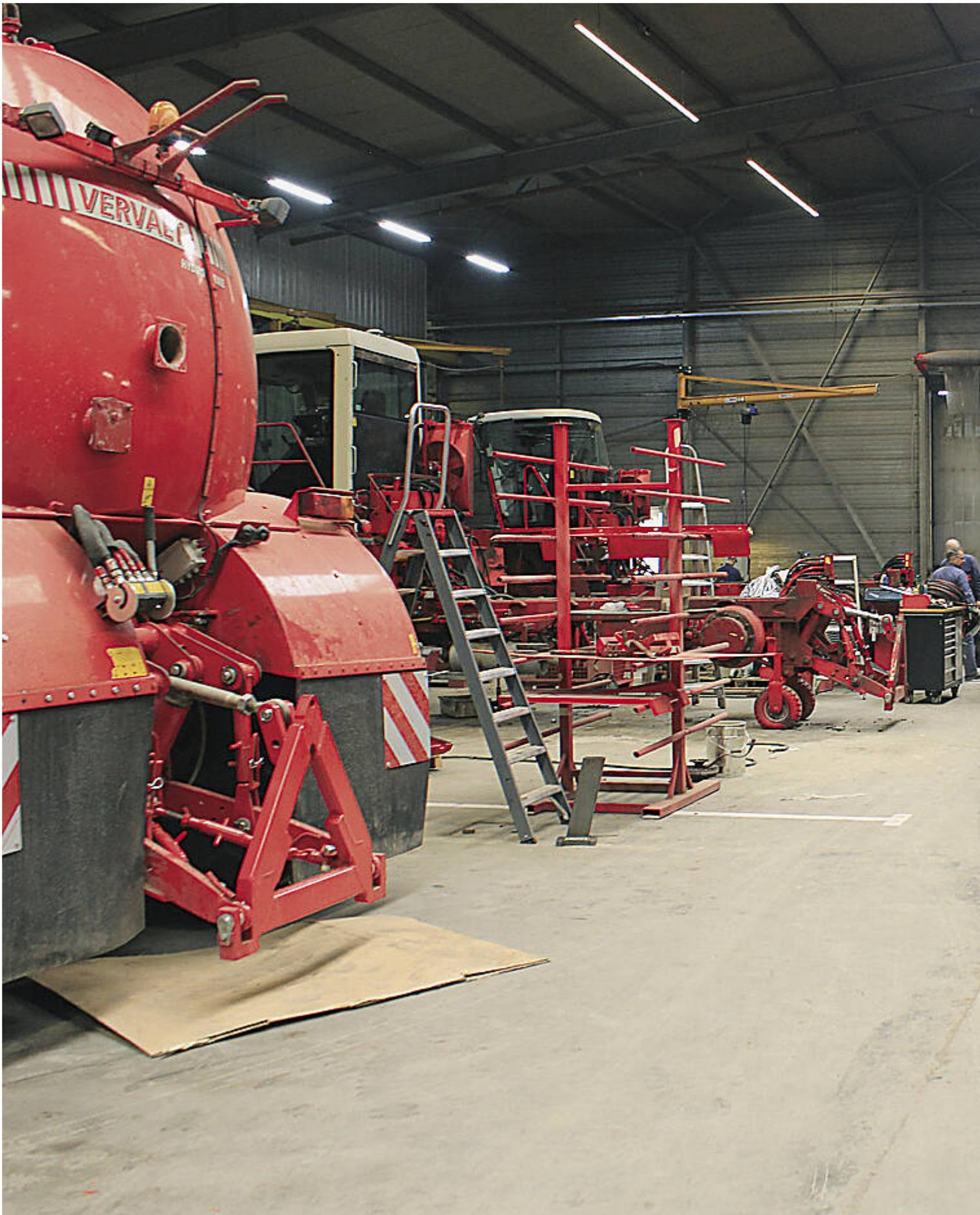
In Zahlung genommene Selbstfahrer werden komplett demontiert, um ihnen im Rahmen des Rebuild-Programms ein zweites Leben zu geben.
