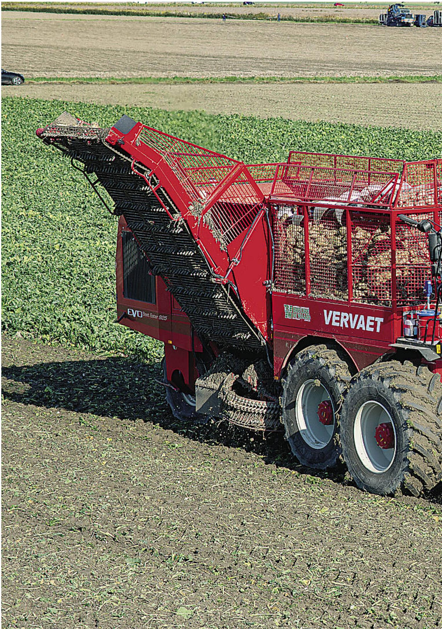
Einfachüberrollung und Hangstabilität: Beim neunreihigen Beet Eater 925 kann die erste von zwei Vorderachsen nach außen teleskopiert werden.
