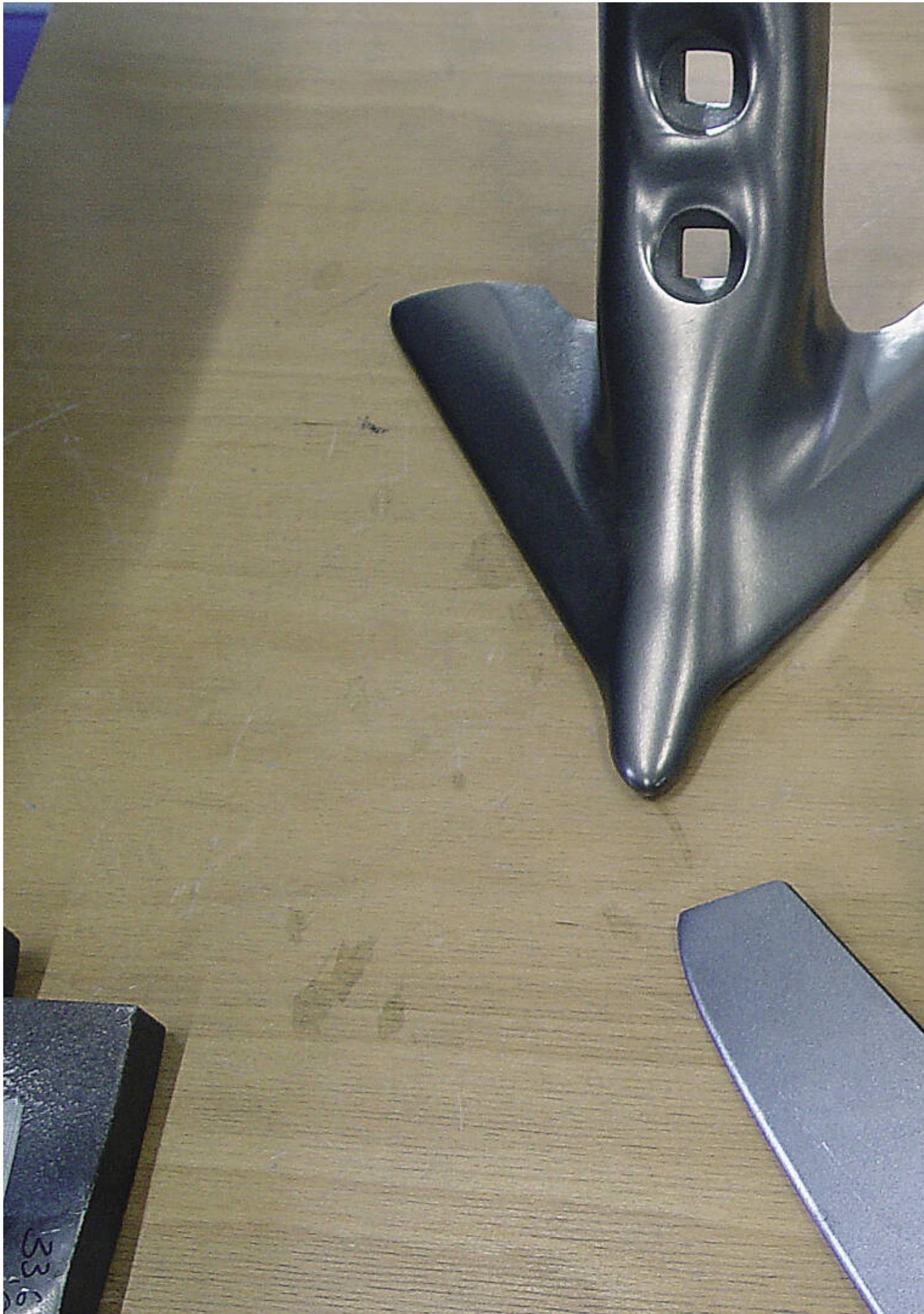
Gänsefuß-Schar aus Stahl (vorn) nach einer Saison, Schar aus Guss mit einer linienförmigen Struktur auf der Unterseite (links) nach dreifacher und Schar mit Verstärkung aufgelöteter Hartmetall-Plättchen nach ca. zwölffacher Leistung des Stahlschares.
