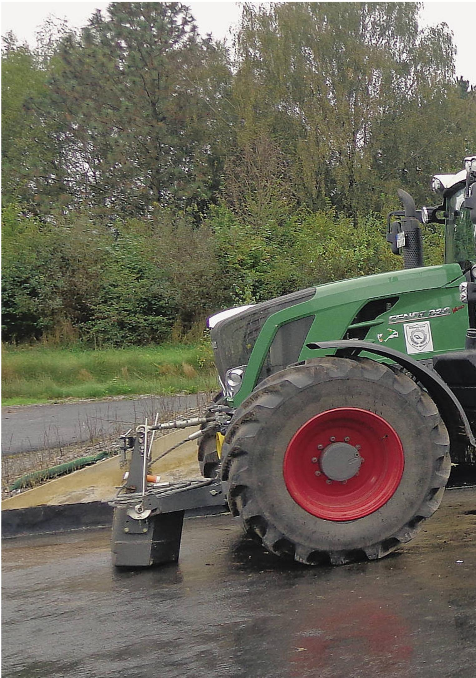
Unter anderem die maximalen Abmessungen, Stützlasten und die Kenntlichmachung müssen bei der Gestängenausrüstung eines Güllefasswagens beachtet werden.
