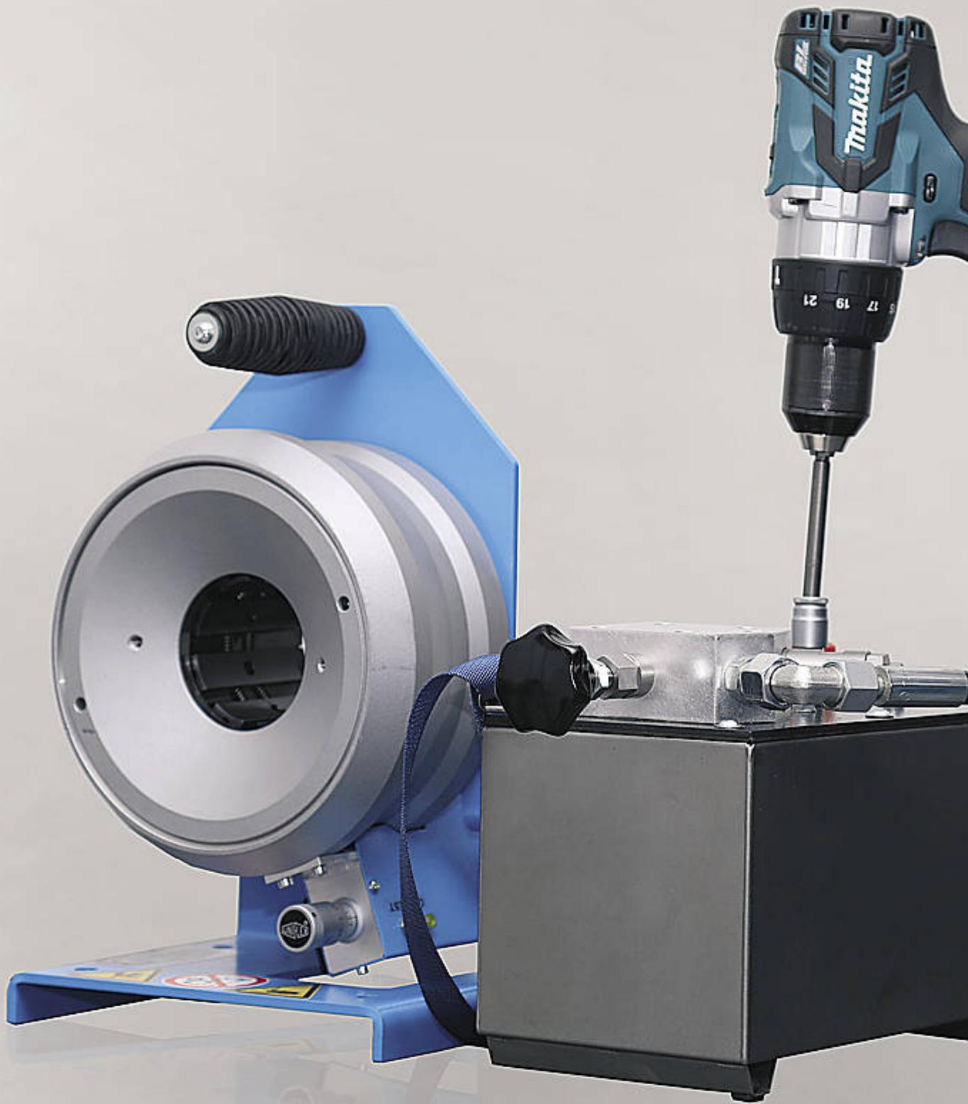
Das mobile Hochdruckaggregat mit kompakter Bauweise wiegt 8,5 kg und lässt sich durch einen Schulter- oder Halsgurt einfach mitnehmen.
