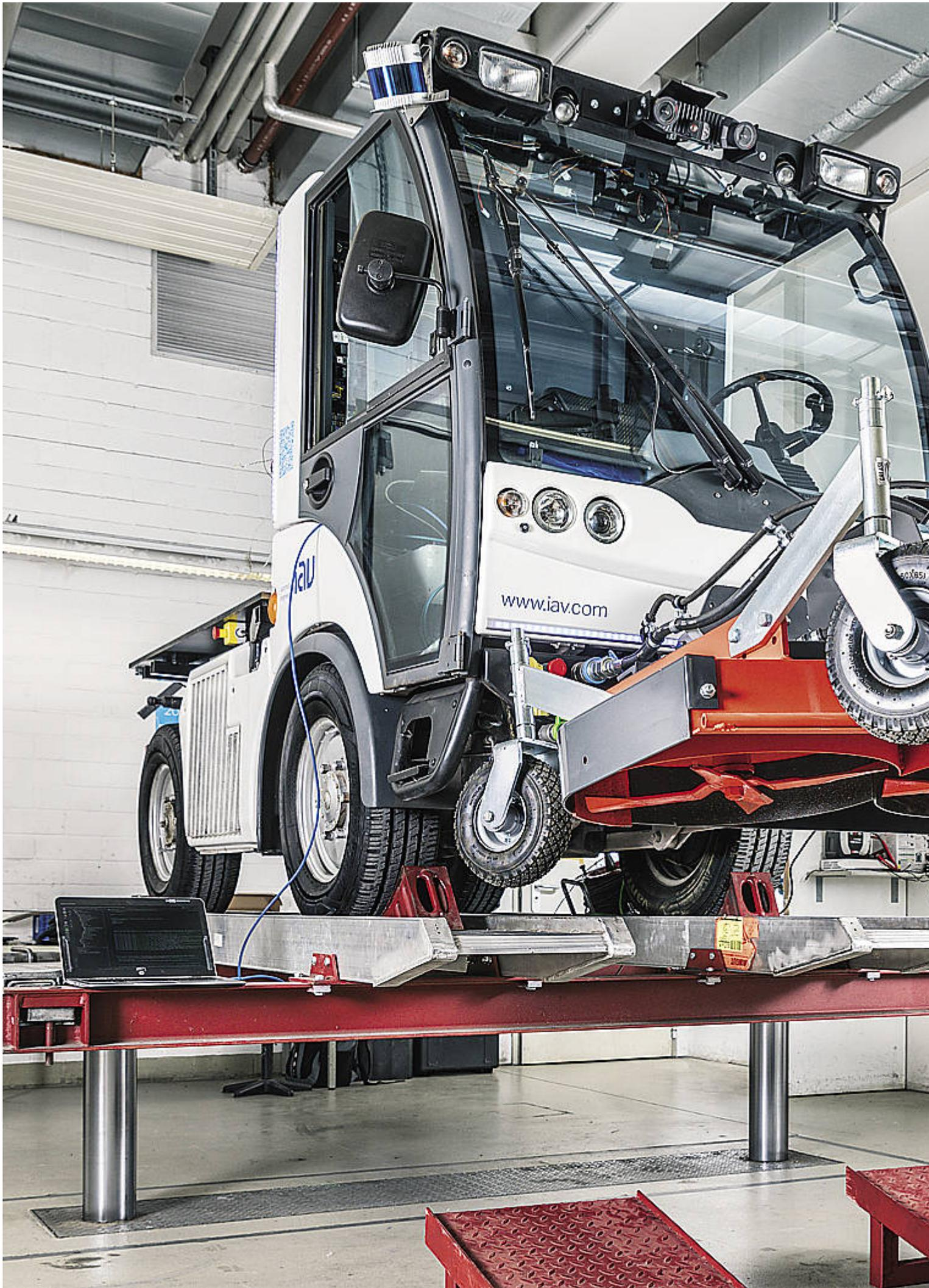
Der Multicar umgerüstet zu einem autonomen Nutzfahrzeug.
