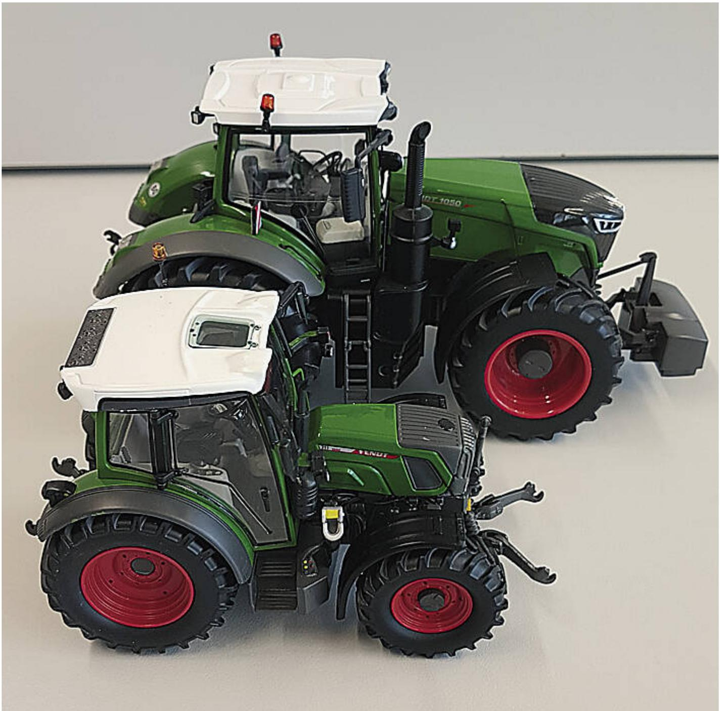
Dreimal mehr Traktor für knapp einen Meter mehr Radstand: 1000er-Fendt mit 3,30 m Radstand und rund 14 t Leergewicht, 200er-Fendt mit 2,32 m Radstand und rund 4,5 t Leergewicht.
