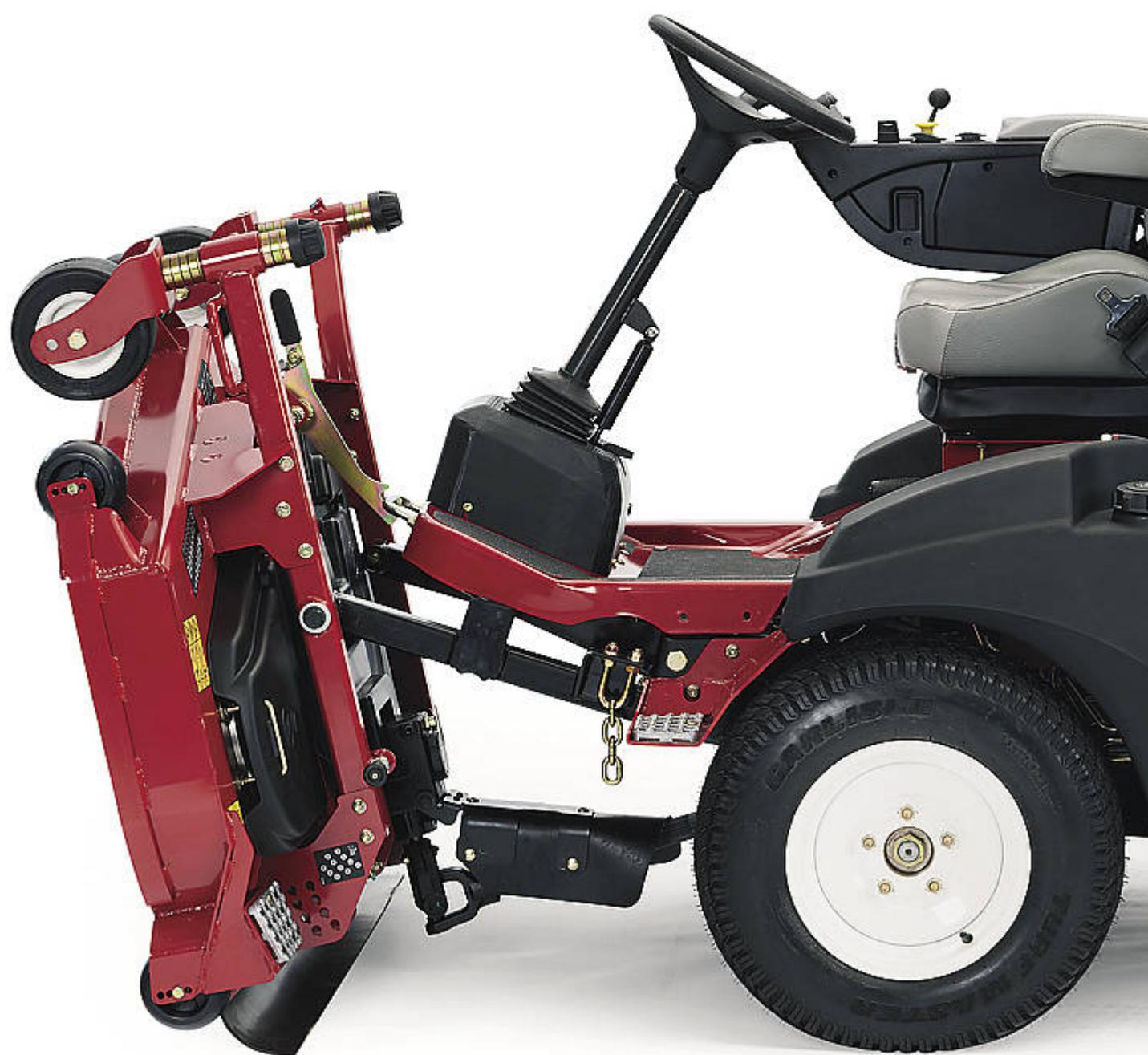
Das Mähwerk ist bis zu knapp 90 Grad klappbar.
