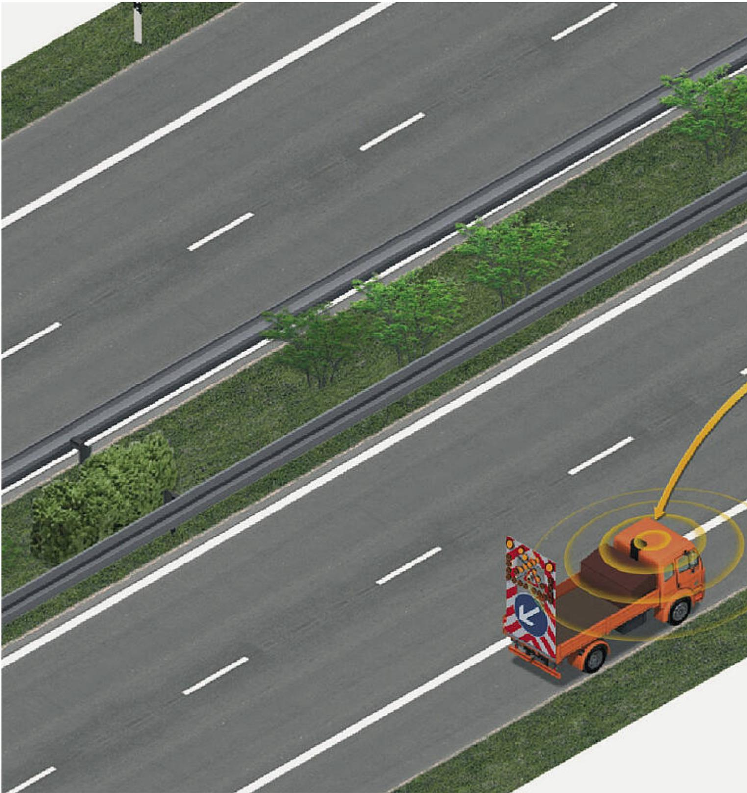
WLAN-Kommunikation zwischen Arbeitsfahrzeug und fahrerlos automatisiert fahrendem Absicherungsfahrzeug. Diese Kombination
