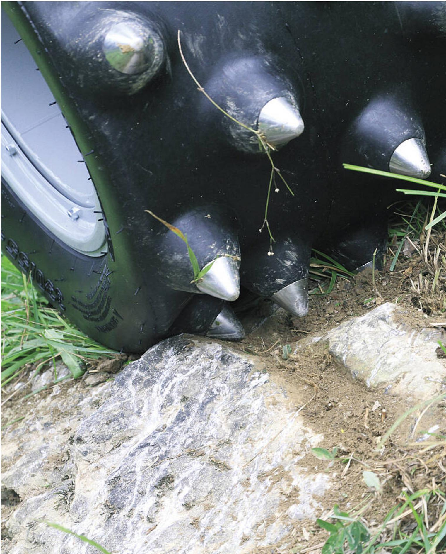
Auf steinigen Böden hält der LS-Grip deutlich besser als Metall-Stachelräder.
