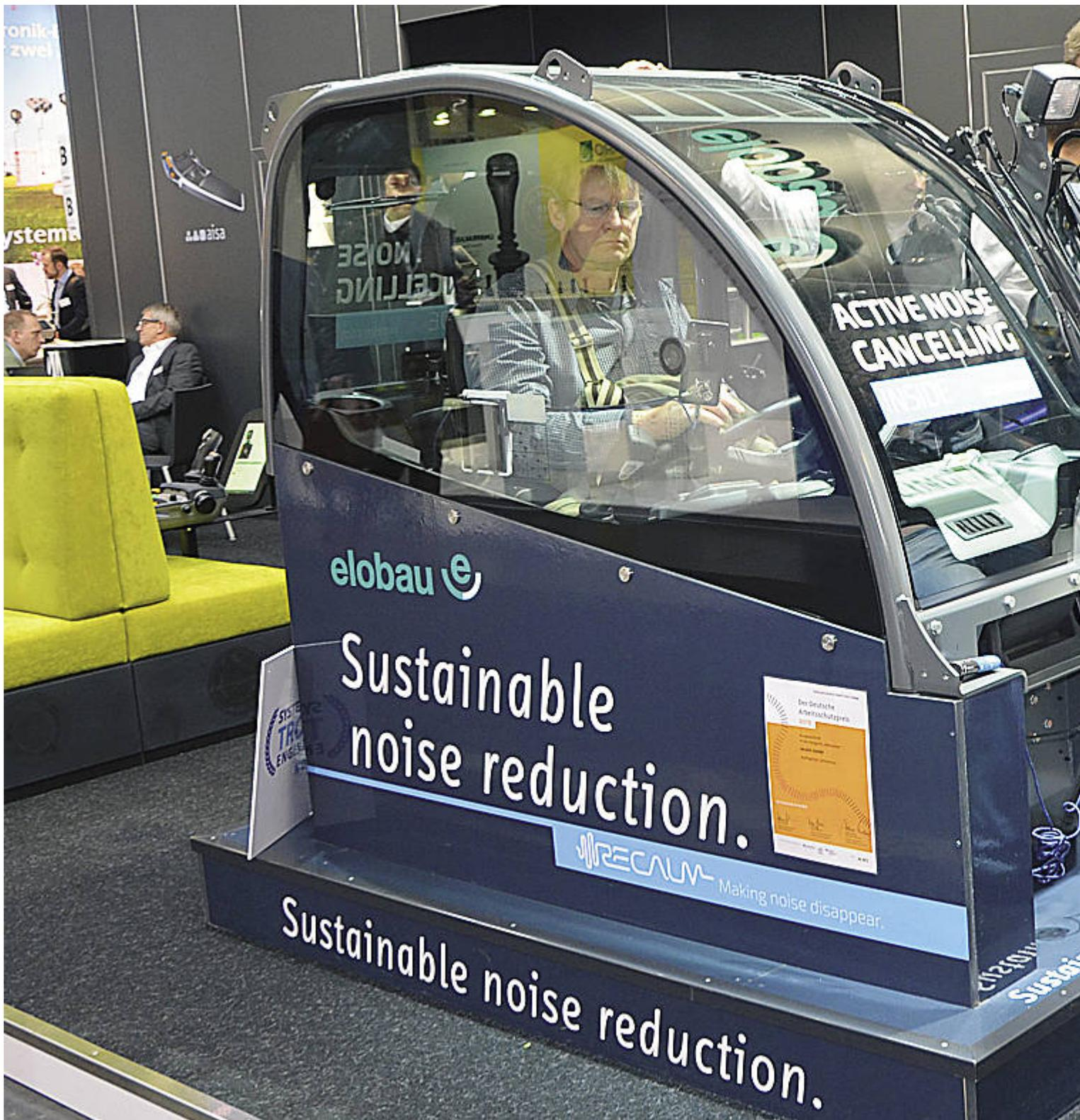
Das Akustikgerät „Ancor“ der Firma Recalm senkt den vom Fahrer wahrgenommenen Schallpegel in der Kabine deutlich ab.
