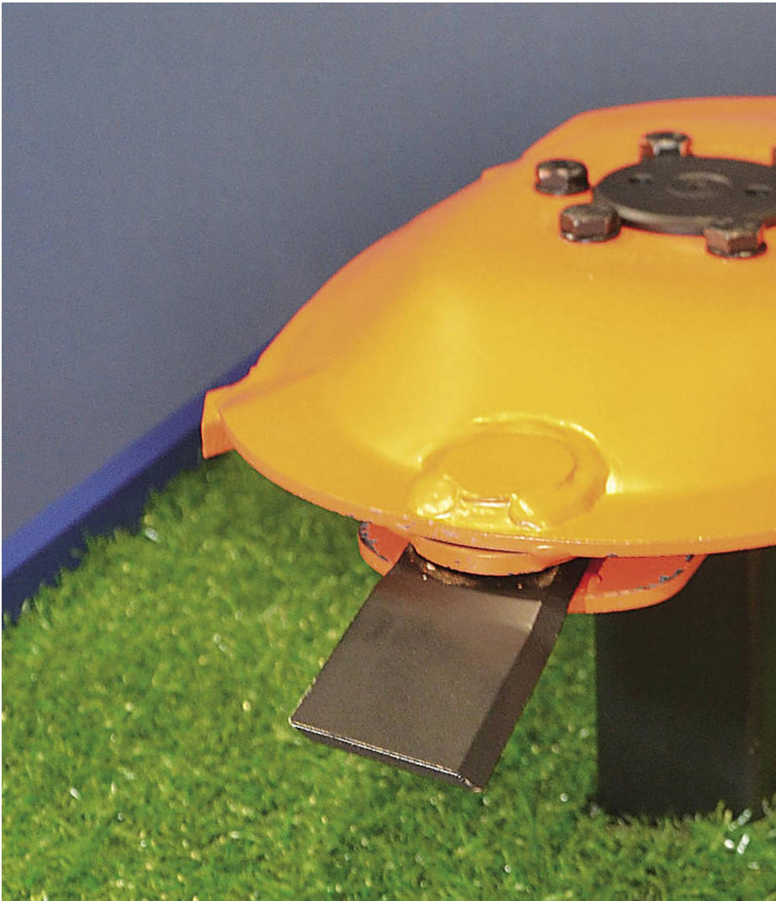
SafeKnives ist ein Sensor für Scheibenmäherwerke, der die Spannkraft der Haltefeder in Echtzeit misst und den aktuellen Zustand ganz gleich ob Verschleiß oder unsachgemäße Montage ursächlich für den Kraftabfall ist.
