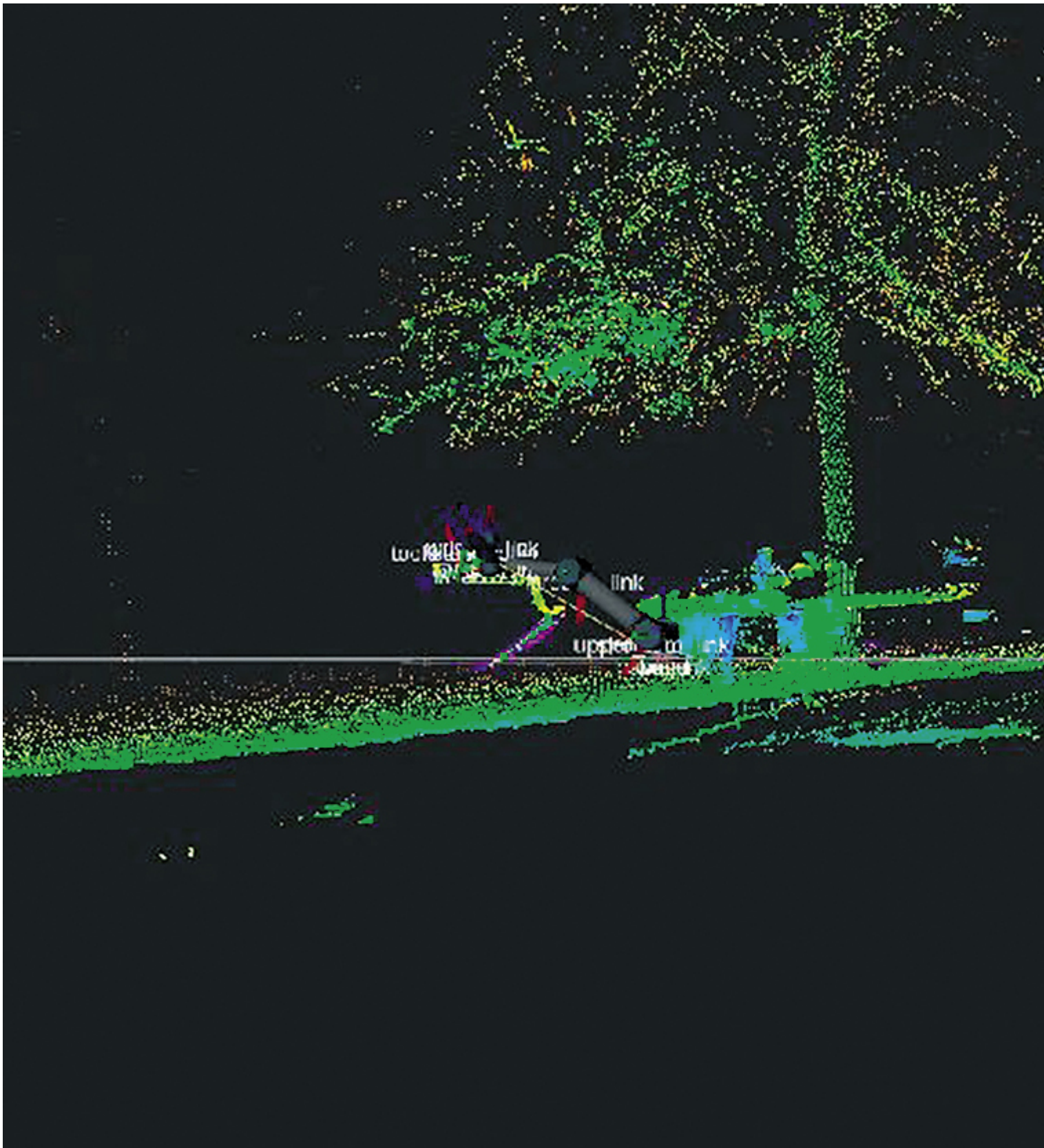
Blick des Roboters: Jede Einzelmessung per Laser markiert einen Punkt im dreidimensionalen Raum, sehr viele davon ergeben ein erkennbares Objekt.
