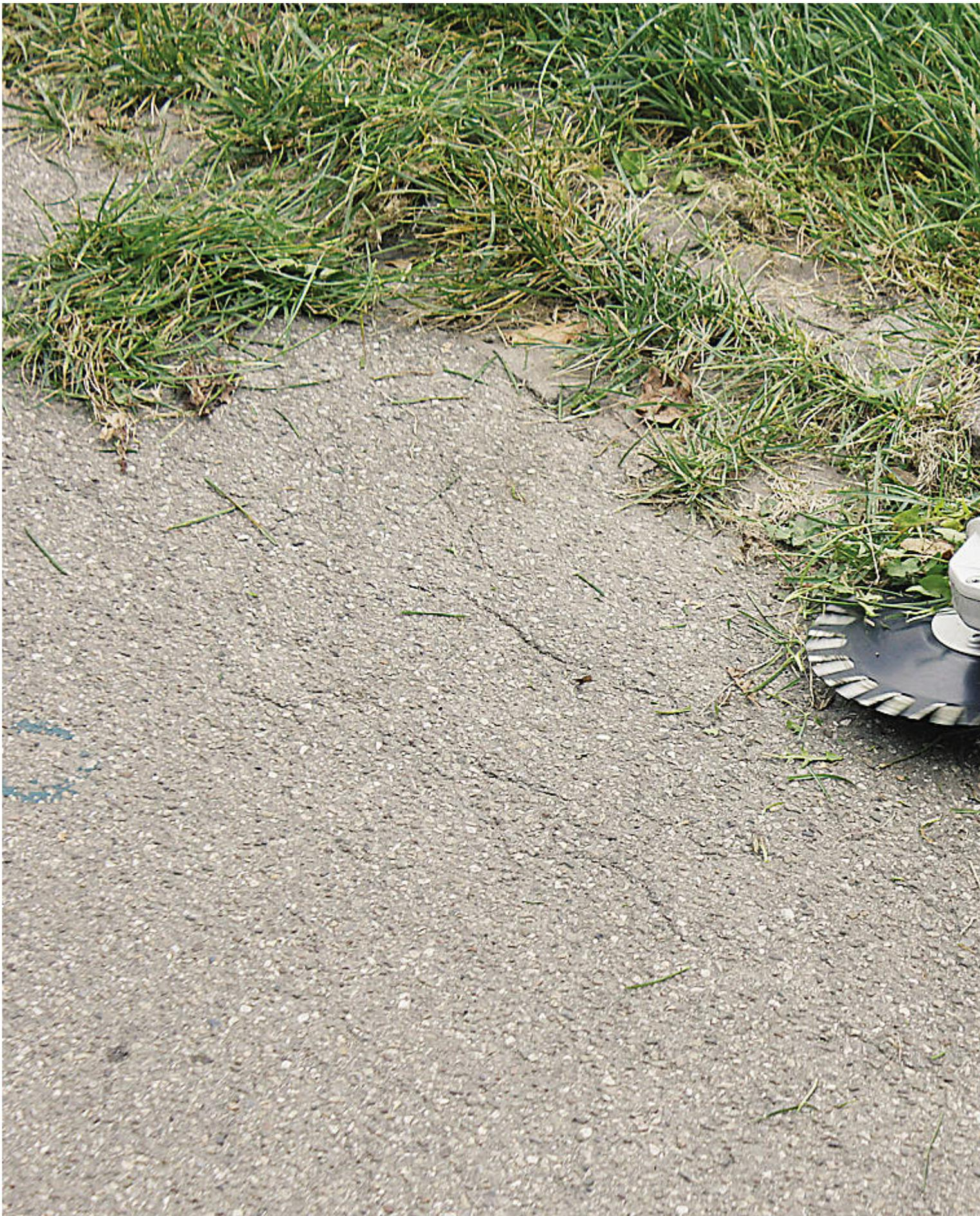
Der RG-Unkrautentferner arbeitet mit zwei gegenläufig oszillierenden Messern.
