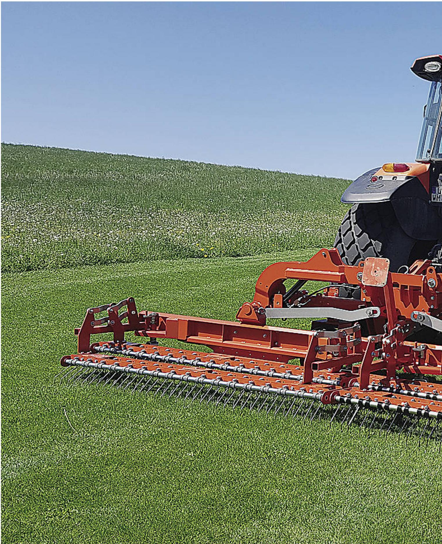
Der Terra Rake von Wiedenmann entfernt abgestorbene Pflanzenteile, Blätter oder oberflächige Wurzeln, denn der Rasenfilz ver-
