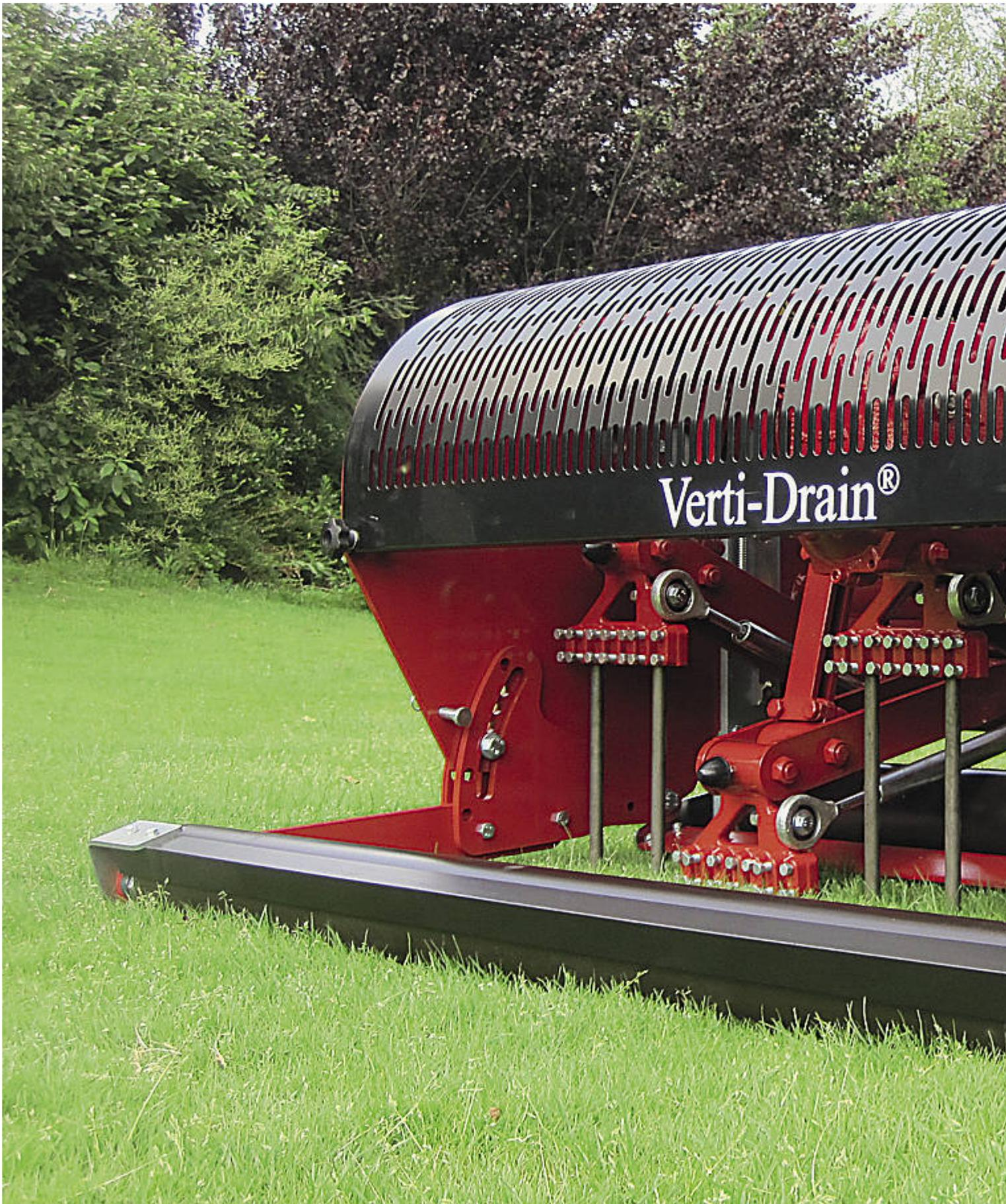
Das Aerifizieren sorgt für einen dichten, stabilen Bewuchs. Aktive Geräte wie der Verti-Drain stechen dazu in den Boden und heben ihn auf, um den Boden dagegen nur zu perforieren.
