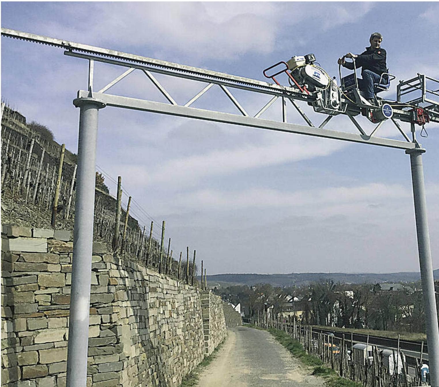
Die Monorackbahn erschließt Steilhänge für die Mechanisierung.
