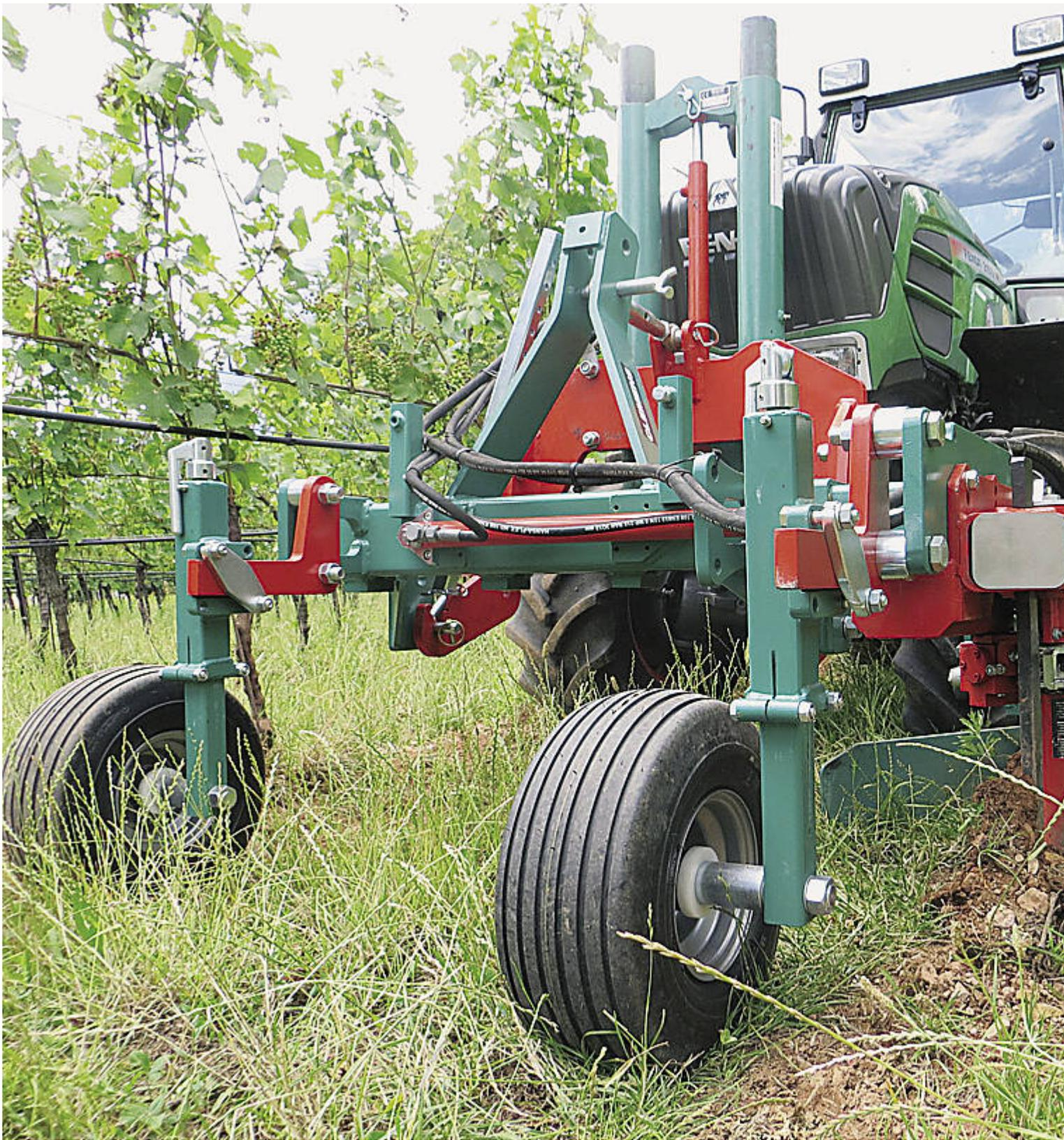
SB Rahmen in der Frontdreipunkt mit Radius SL zur Unterstockbearbeitung.
