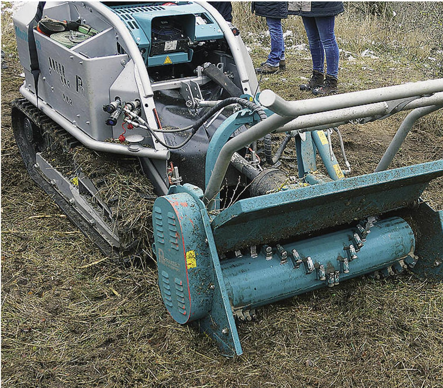
Der Mulchvorsatz der ferngesteuerten Fäll- und Rückeraupe Moritz Fr50 hat eine Arbeitsbreite von 1,50 m. Die Motorleistung be
