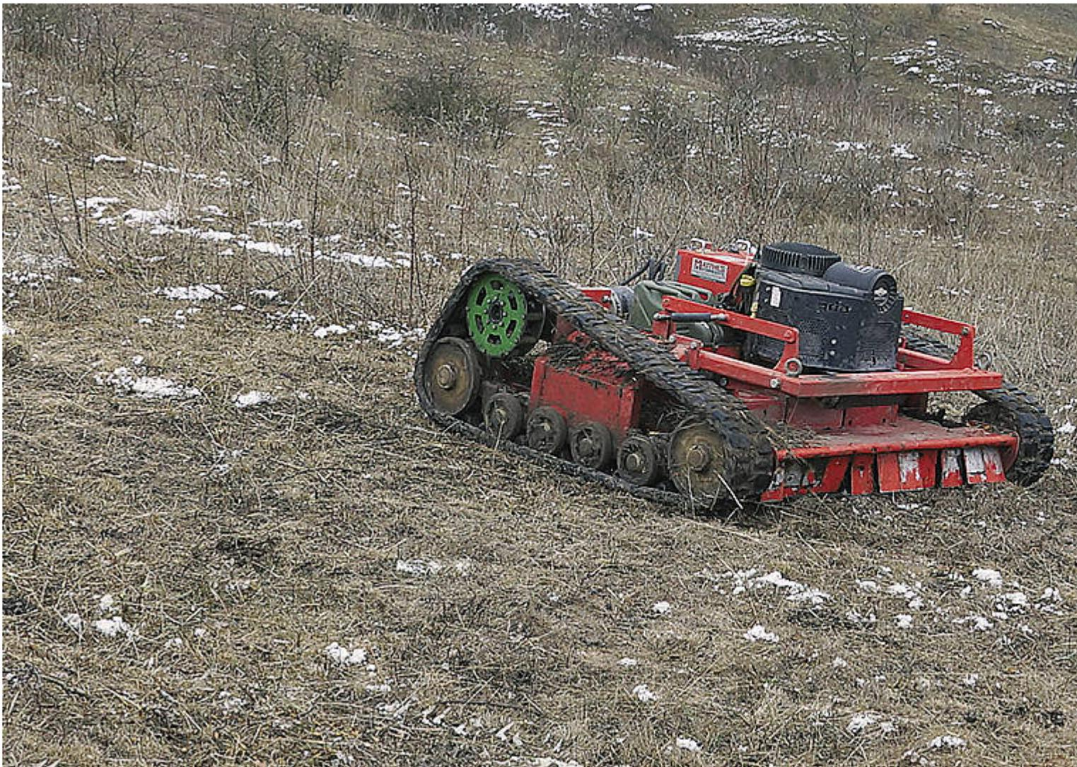
Das Raupenfahrwerk des Hochgras-Sichelmulchers Agridia 9600 wird elektrisch angetrieben. Damit stehen die 20 PS des aufges
