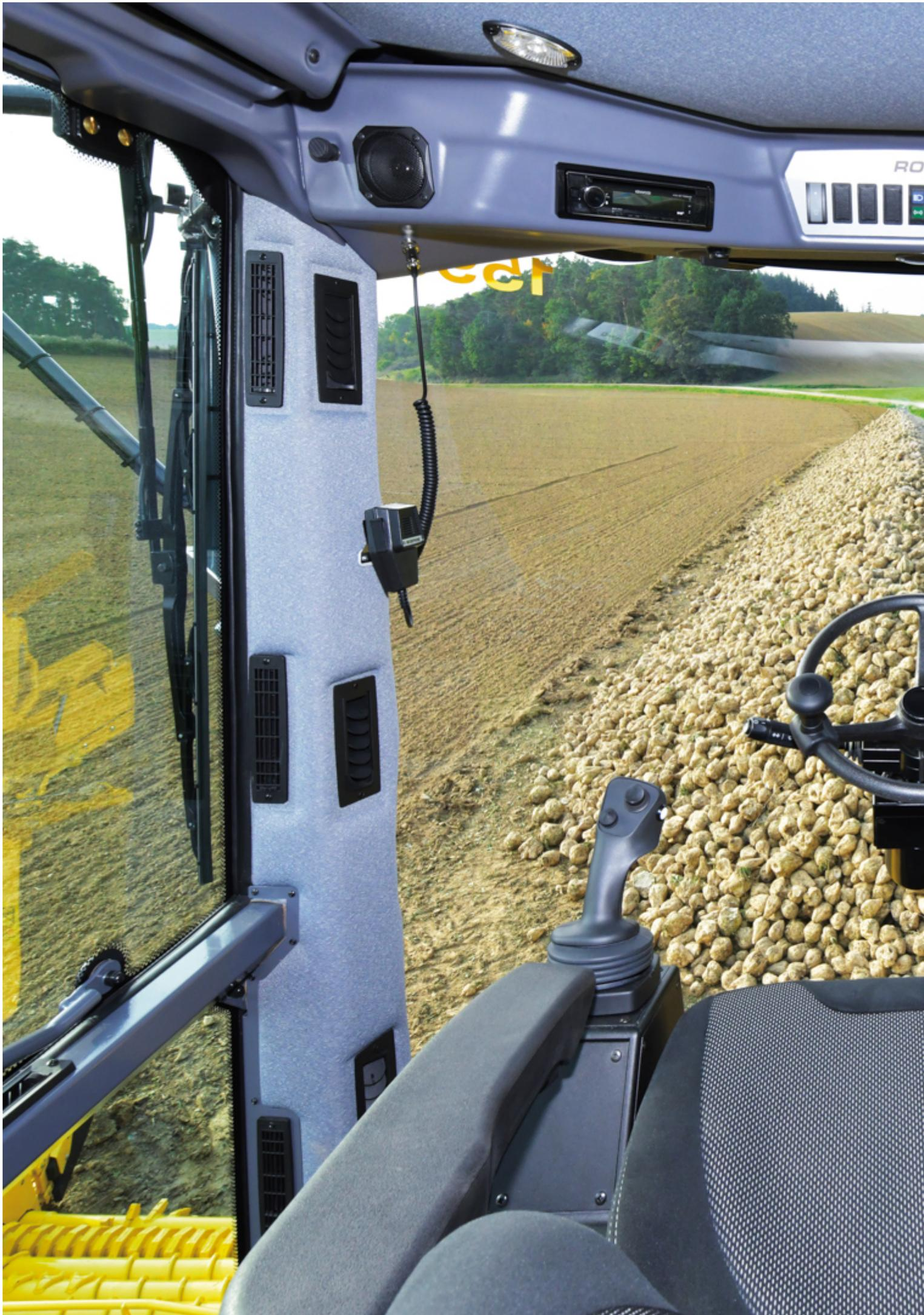
Die neue Panoramakabine mit zwei 12,1 Zoll Terminals, integrierter Telematik, neuen Joysticks und Bedienelementen.
