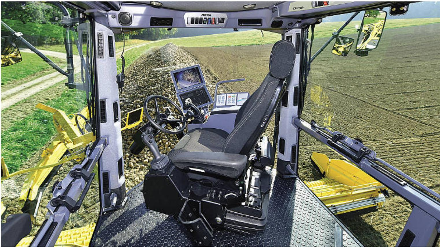
Die neue Panoramakabine mit zwei 12,1 Zoll Terminals, integrierter Telematik, neuen Joysticks und Bedienelementen.
