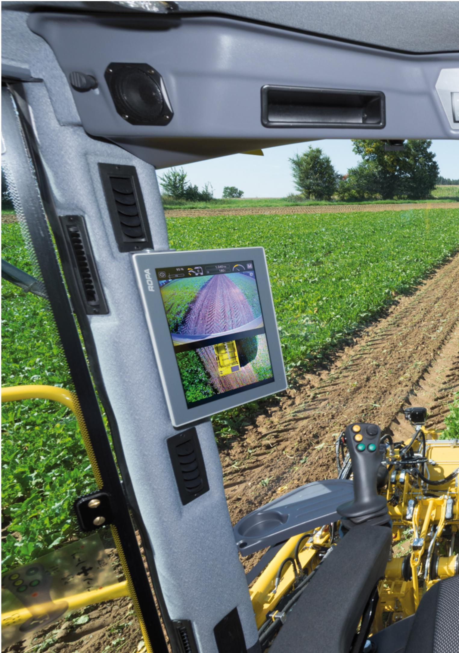
Die Panoramakabine mit zwei 12,1 Zoll Terminals, integrierter Telematik, neuen Joysticks und Bedienelementen.
