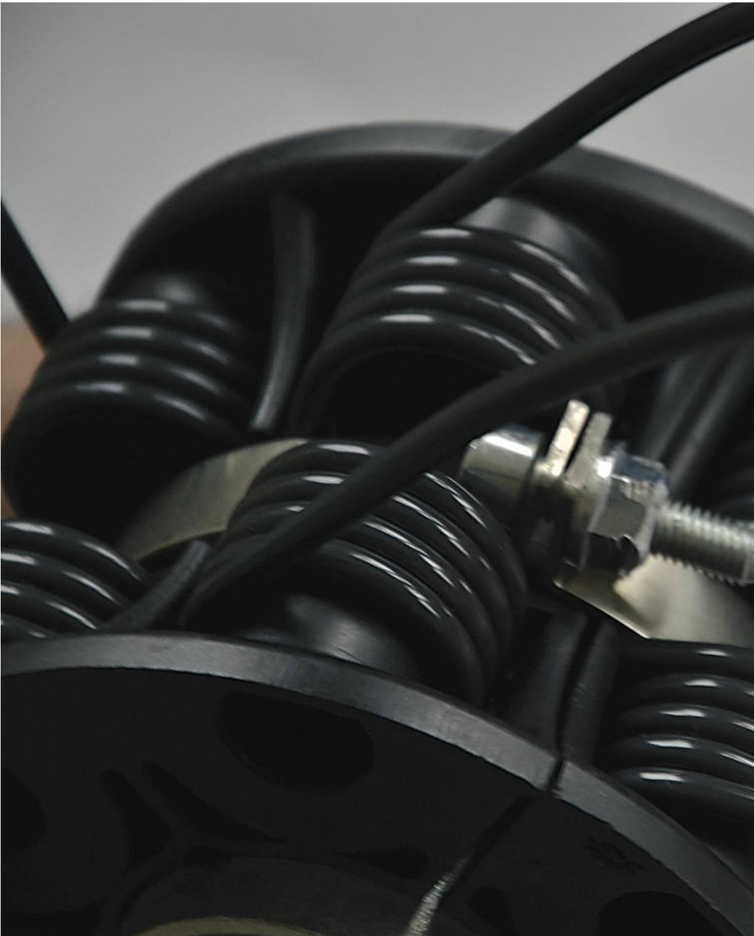
Zinkenbefestigung „Anit-loss“: Eine Schraube mit Federstahlklammer fixiert sechs Zinken. So sollen die Zinken nicht mehr verloren
