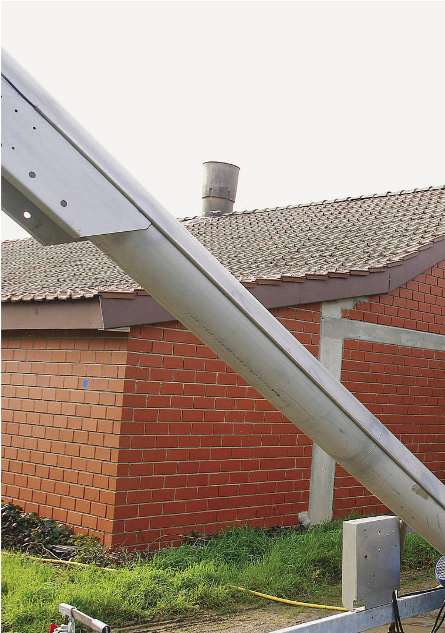
Eine mobile Zentrifuge zur Trennung von Schweinegülle. Über die Schnecke werden Feststoffe direkt auf einen Lkw geladen.
