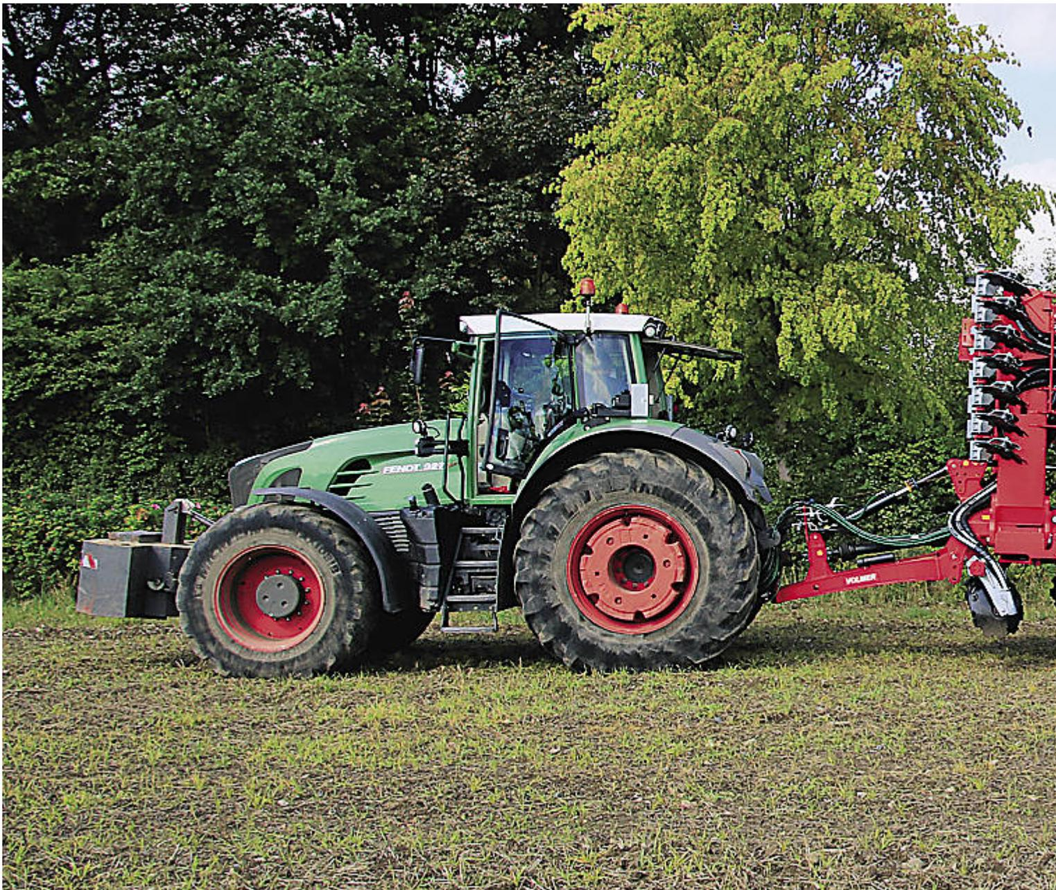
Der Wendekreis innen misst bei dieser Gespannvariante Fendt Vario 927, KTC-System und mit 18 m<sup>3</sup> Zunhammer Fass ca. 10 M
