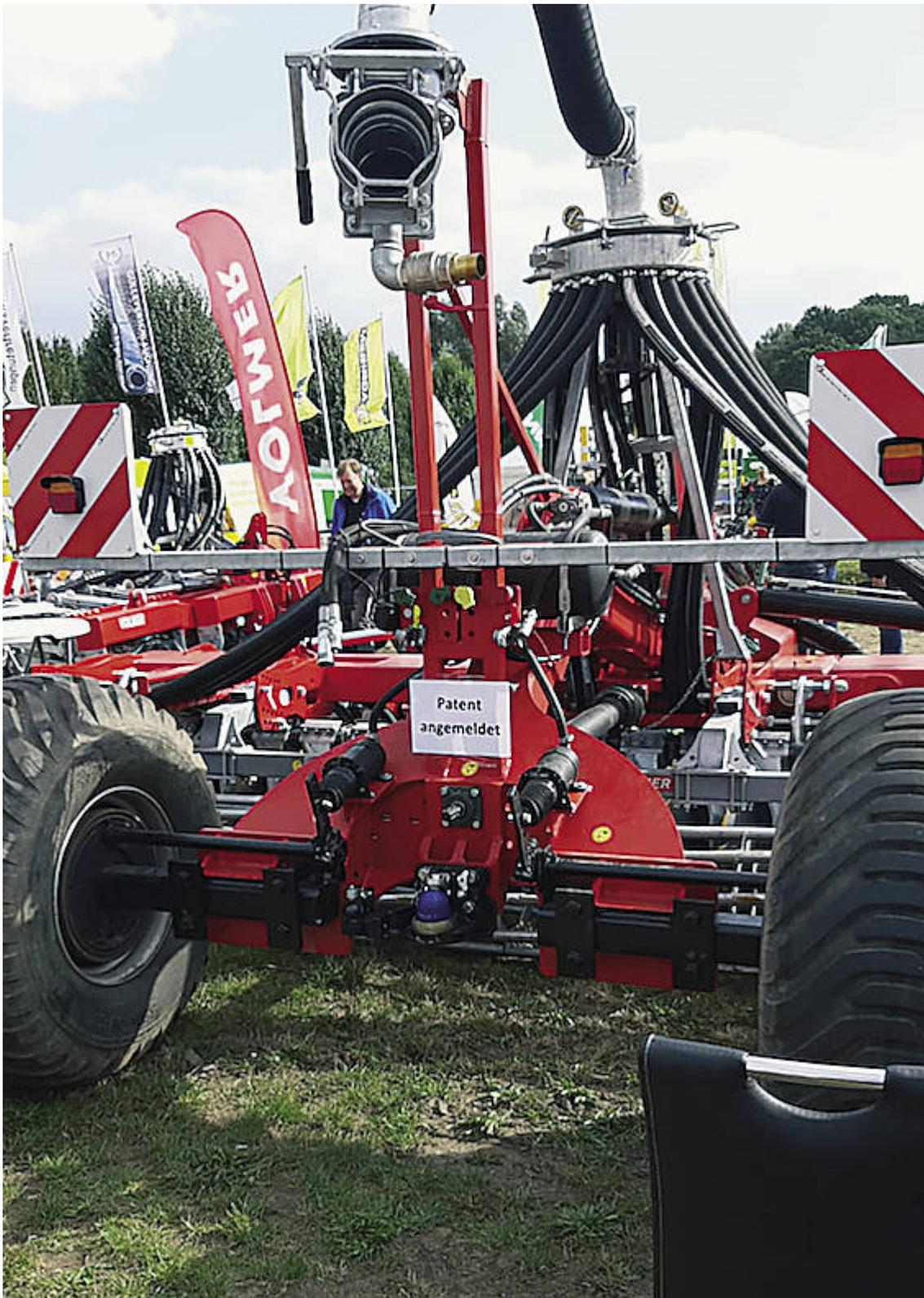
Der Güllefasswagen wird an die K80 des KTC gekuppelt.
