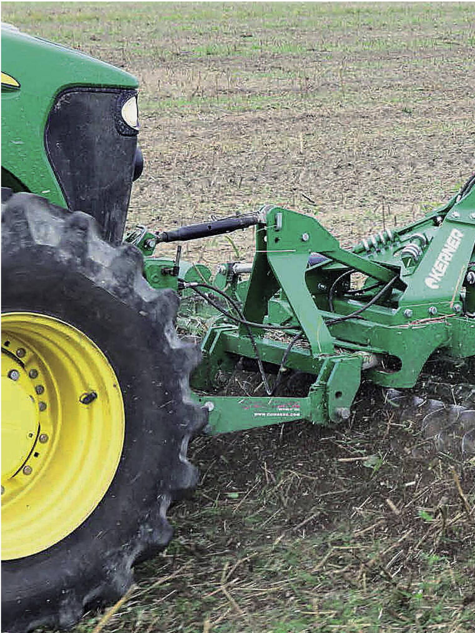
Einfacher Aufbau: Vorn die Messewalze, gefolgt von einer Walze mit Schneidscheiben.
