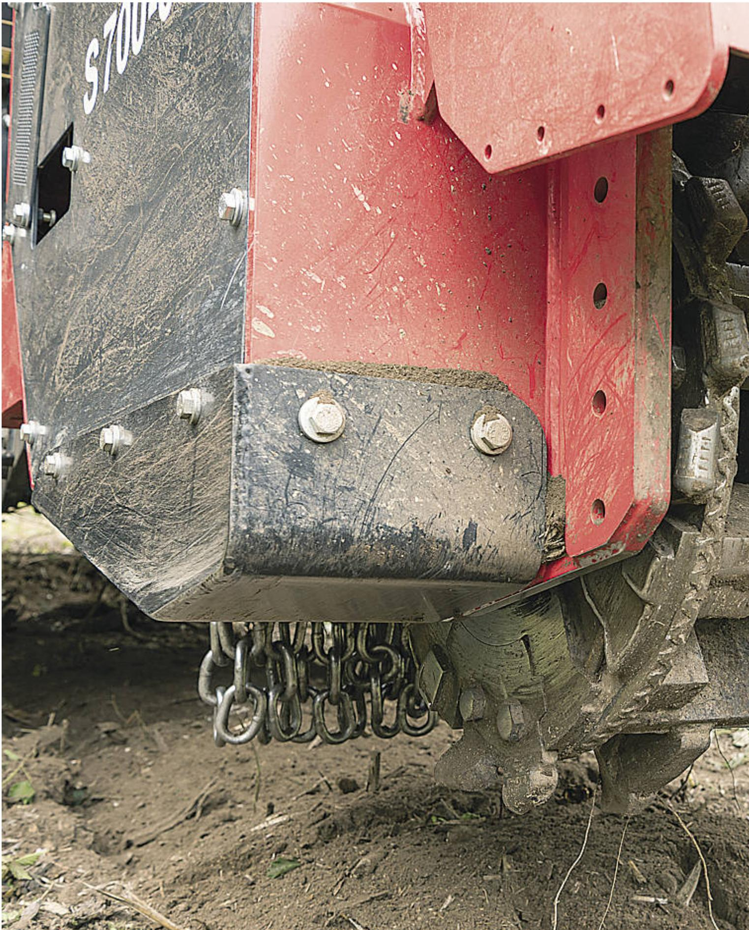
Die per Zapfwelle angetriebene Walze der AHWI-Streifenfräse mit den aufmontierten Meißeln.
