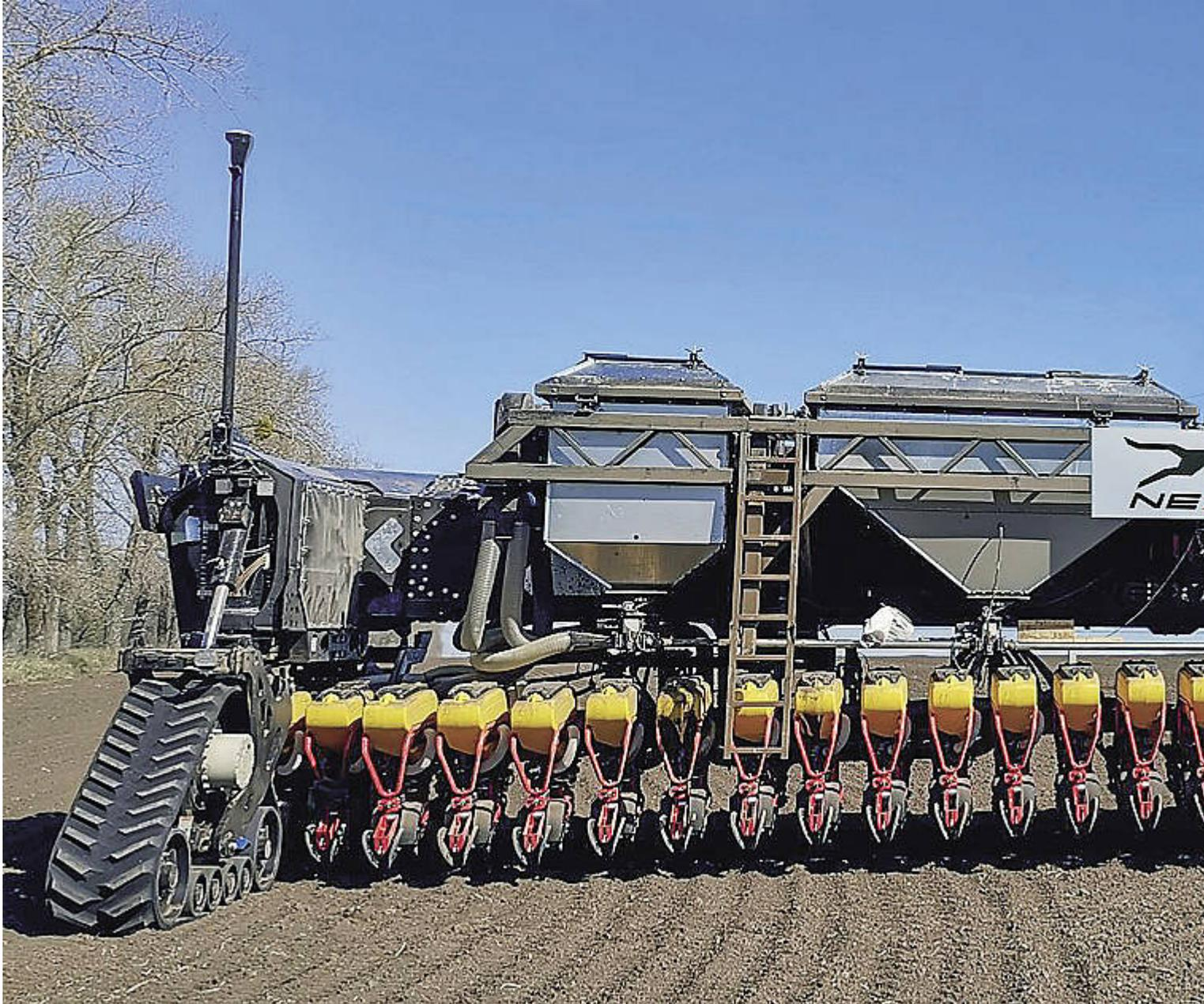
Nexat mit eingehängtem Einzelkornsägerät. Das Gewicht lastet auf vier elektrisch angetriebenen Raupenlaufwerken.
