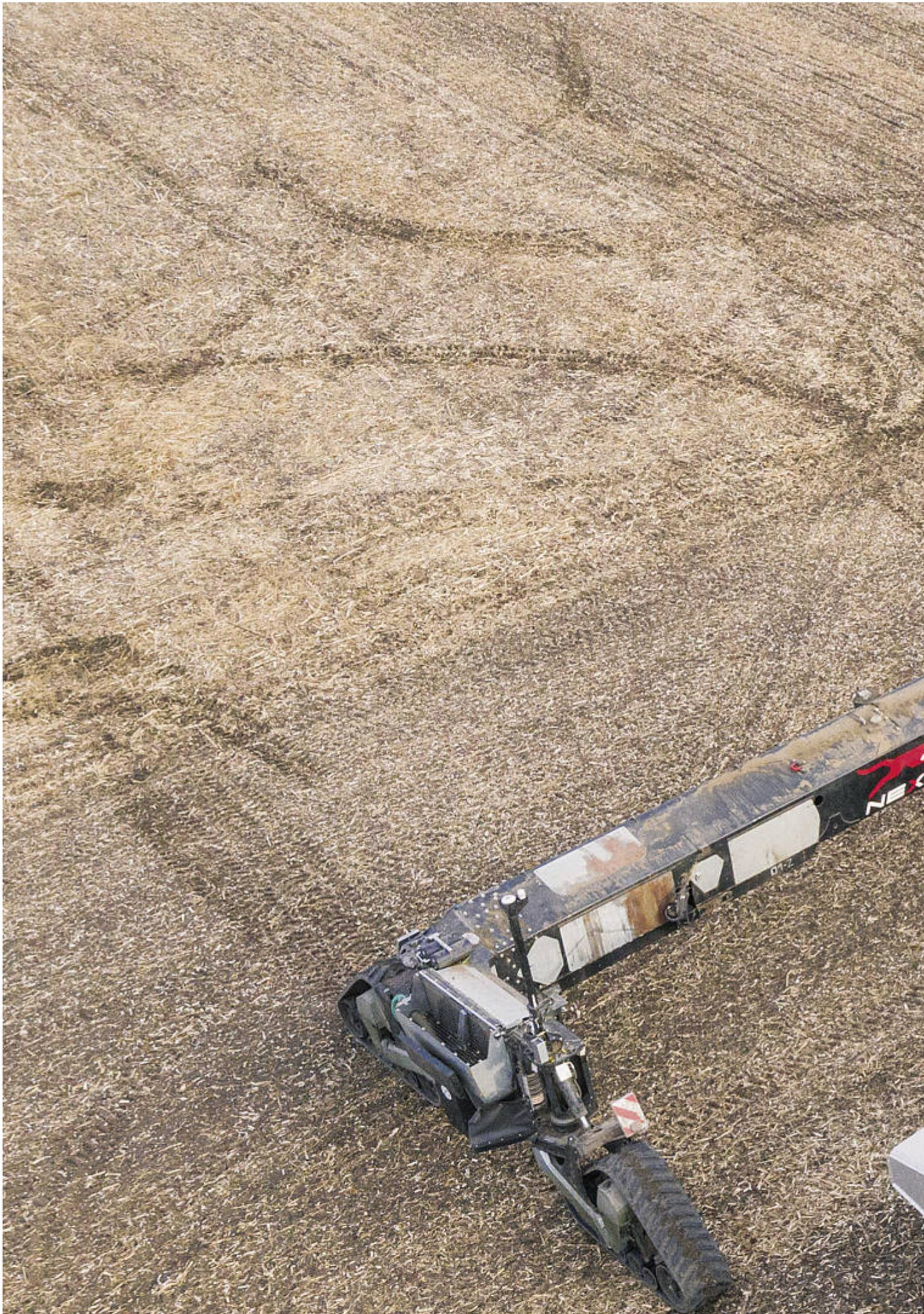
Innerhalb von zehn Minuten können die eingehängten Arbeitsgeräte getauscht werden. In Zukunft soll der Modulwechsel sogar voll- automatisiert möglich sein.
