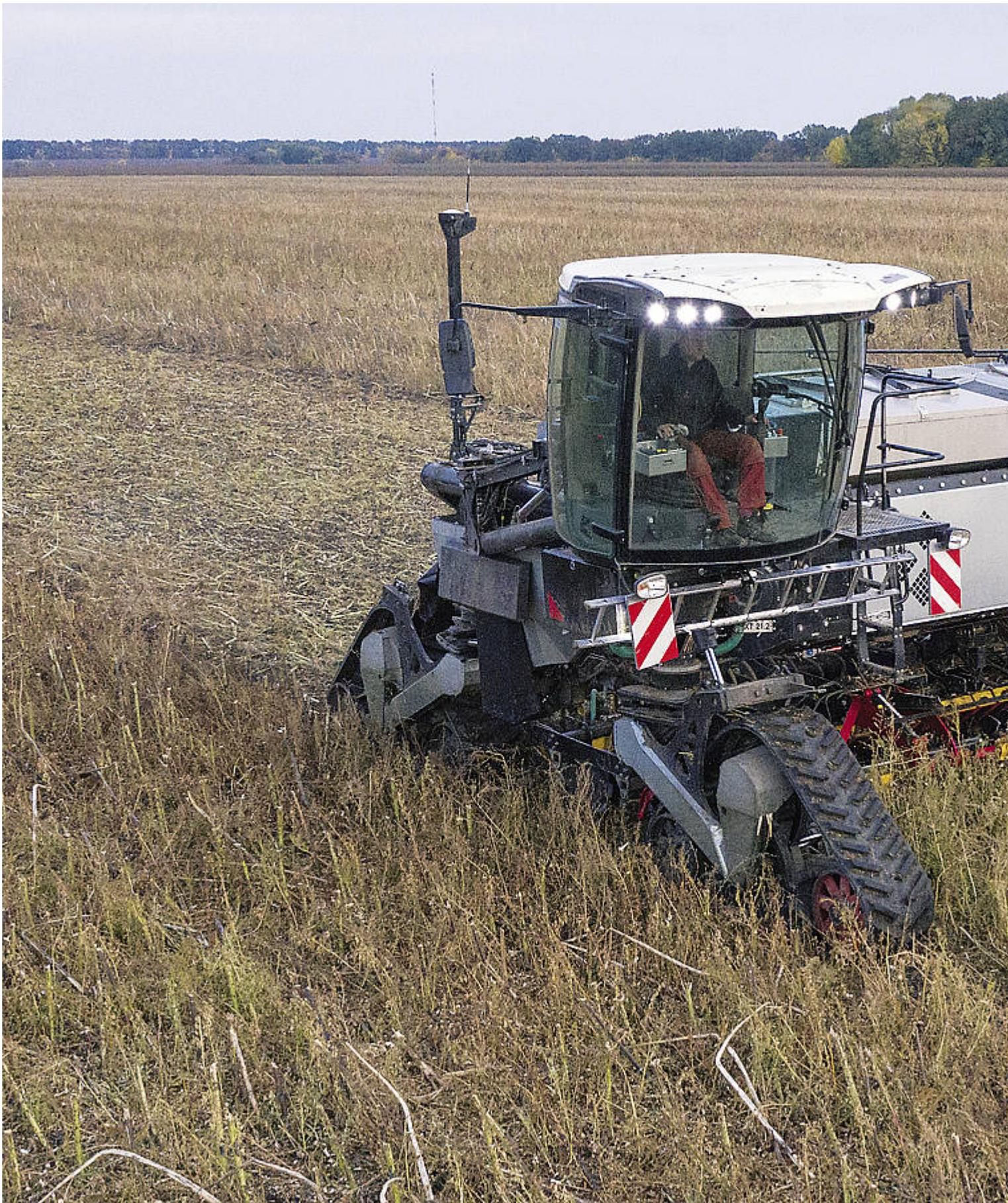
Auch die flache und effektive Bodenbearbeitung erfolgt im bodenschonenden Controlled Traffic Farming (CTF), also auf festen F
