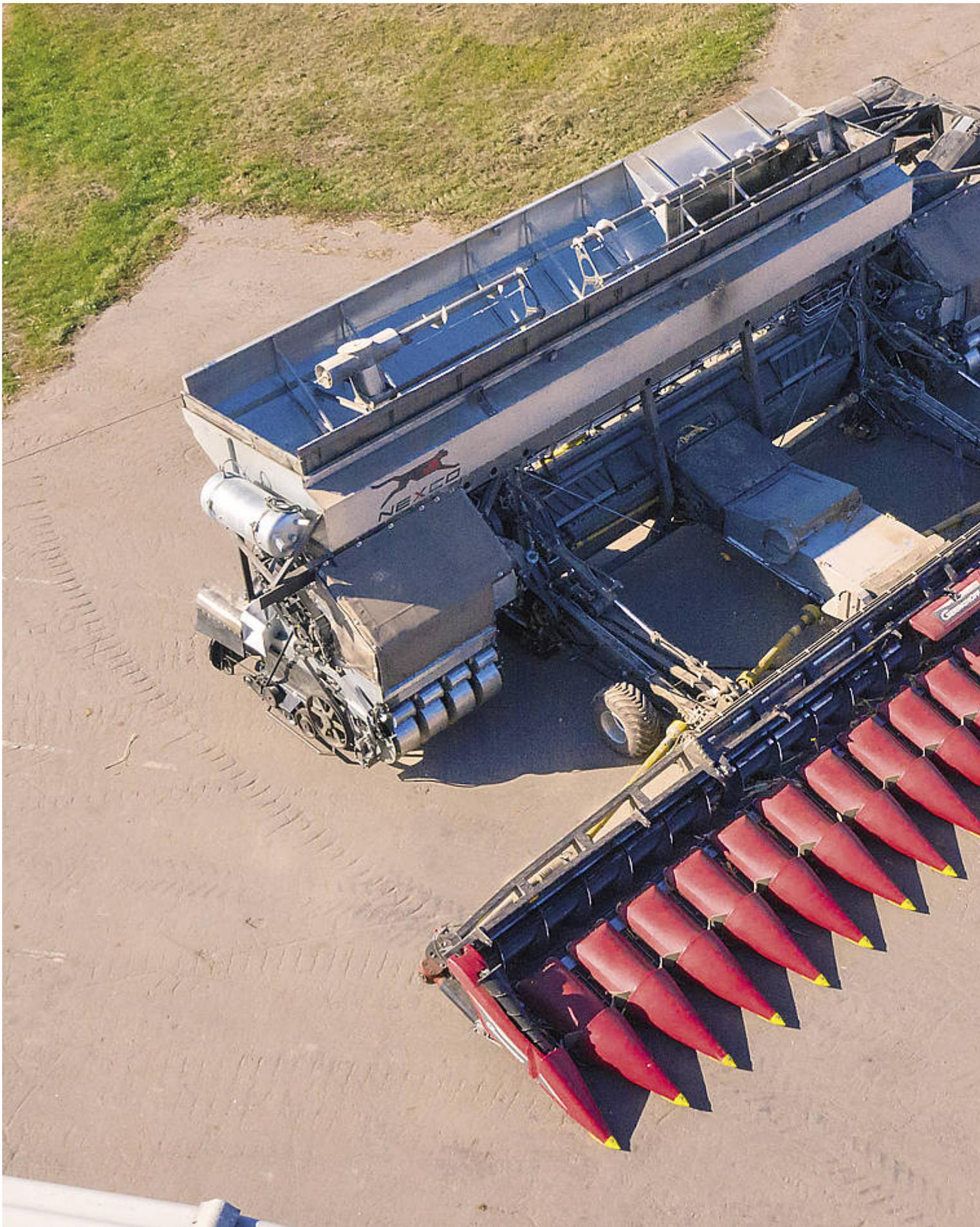
Das NexCo-Mähdeschermodul soll Korndurchsätze von bis zu 200 Tonnen in der Stunde ermöglichen.
