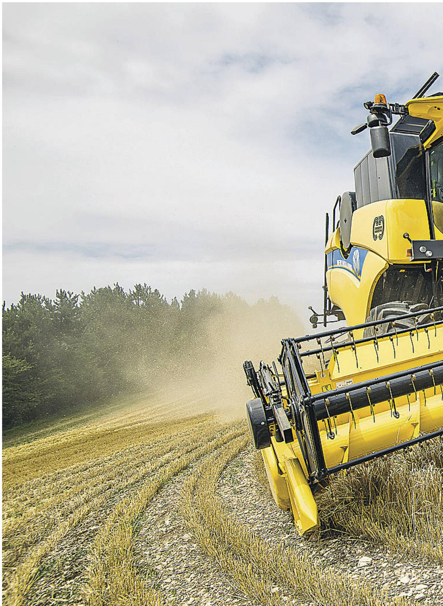
Der Hybriddrescher CH7.70 vereint das konventionelle Zweitrommel-Dreschwerk mit dem Twin-Rotor-System mit 2,9 m<sup>2</sup> Abscheidefläche.
