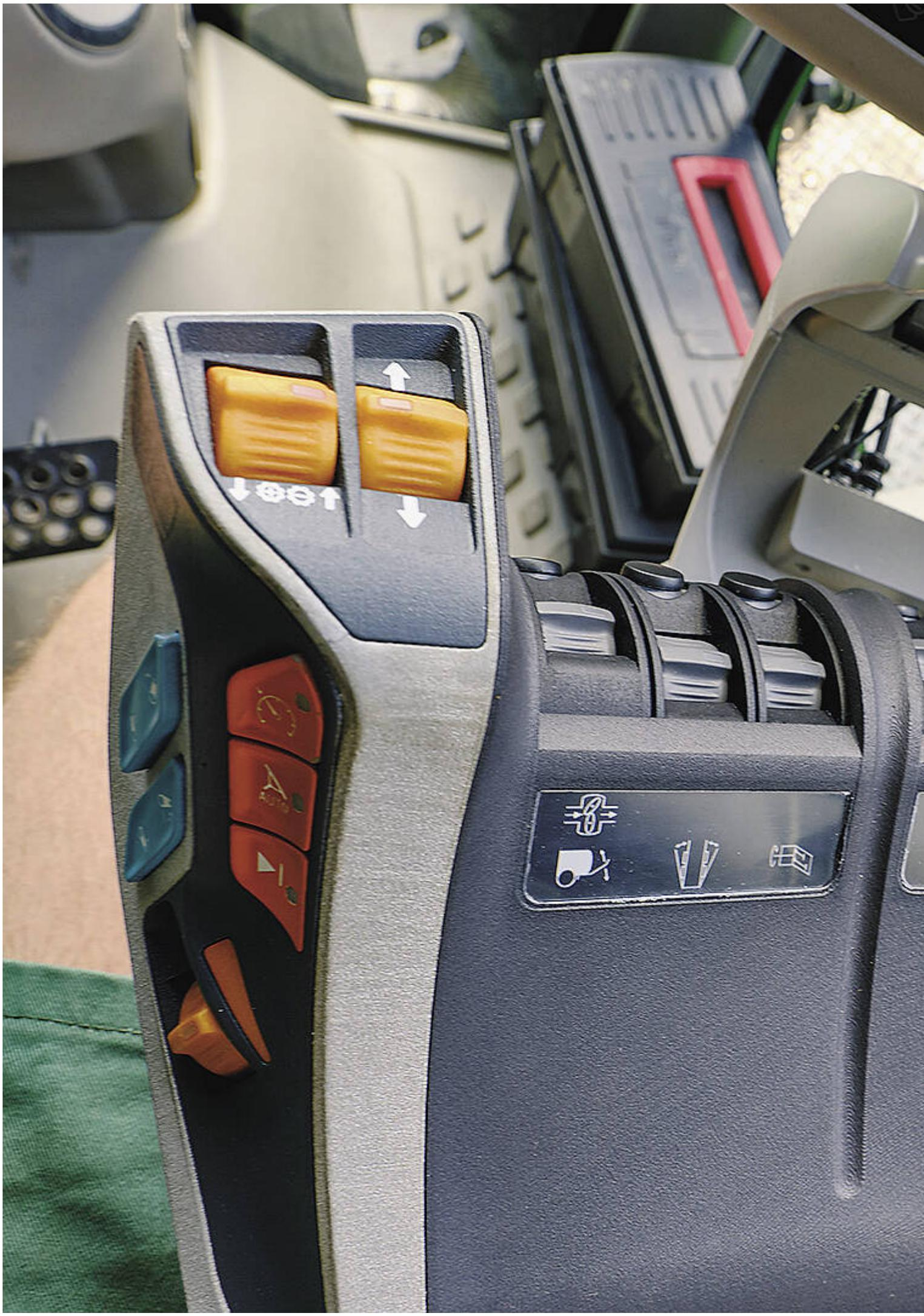
Bedienelemente für die Finger vor den Displays verändern sich, je nachdem welche Maschine angehängt ist.
