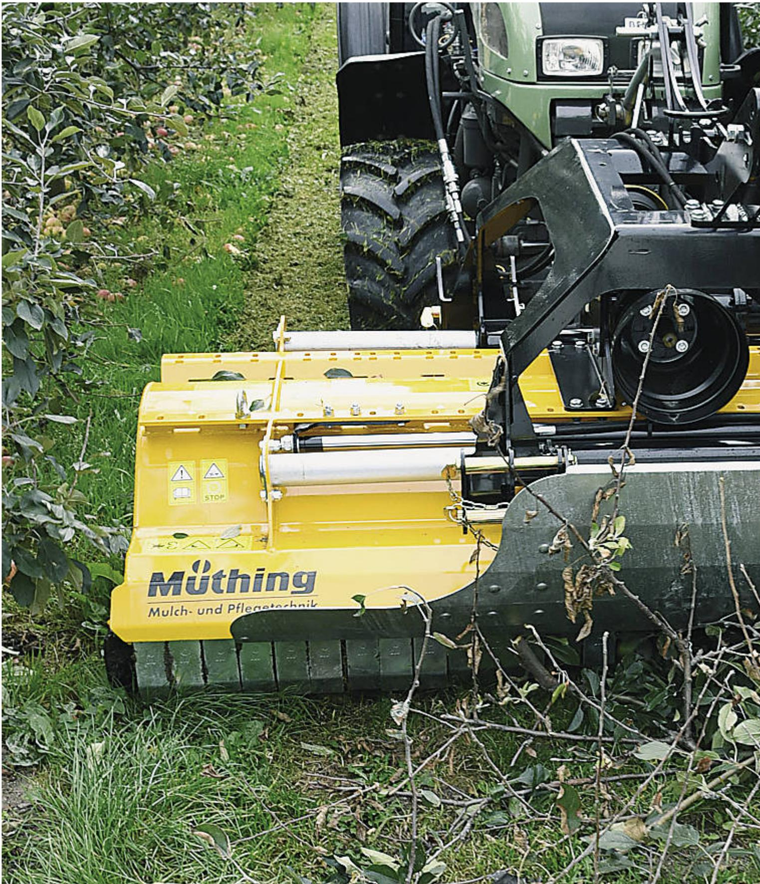
Das MU-O Mulchgerät für den Obstbau und andere Sonderkulturen von 1,6 bis 2,5 m für Traktorenleistungen von 40 bis 130 PS
