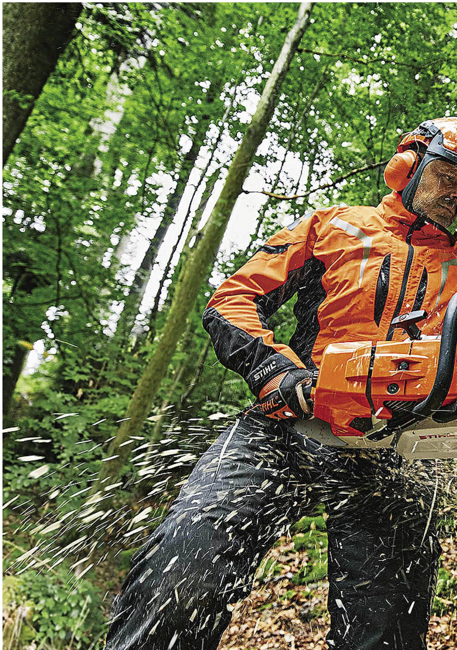
Auf sehr großen Sägen wie der neuen Stihl 881 – laut Hersteller die stärkste Seriensäge der Welt – werden bis zu 105 Zentimeter lange Schwerter sowie die großen Ketten der .404-Teilung eingesetzt.
