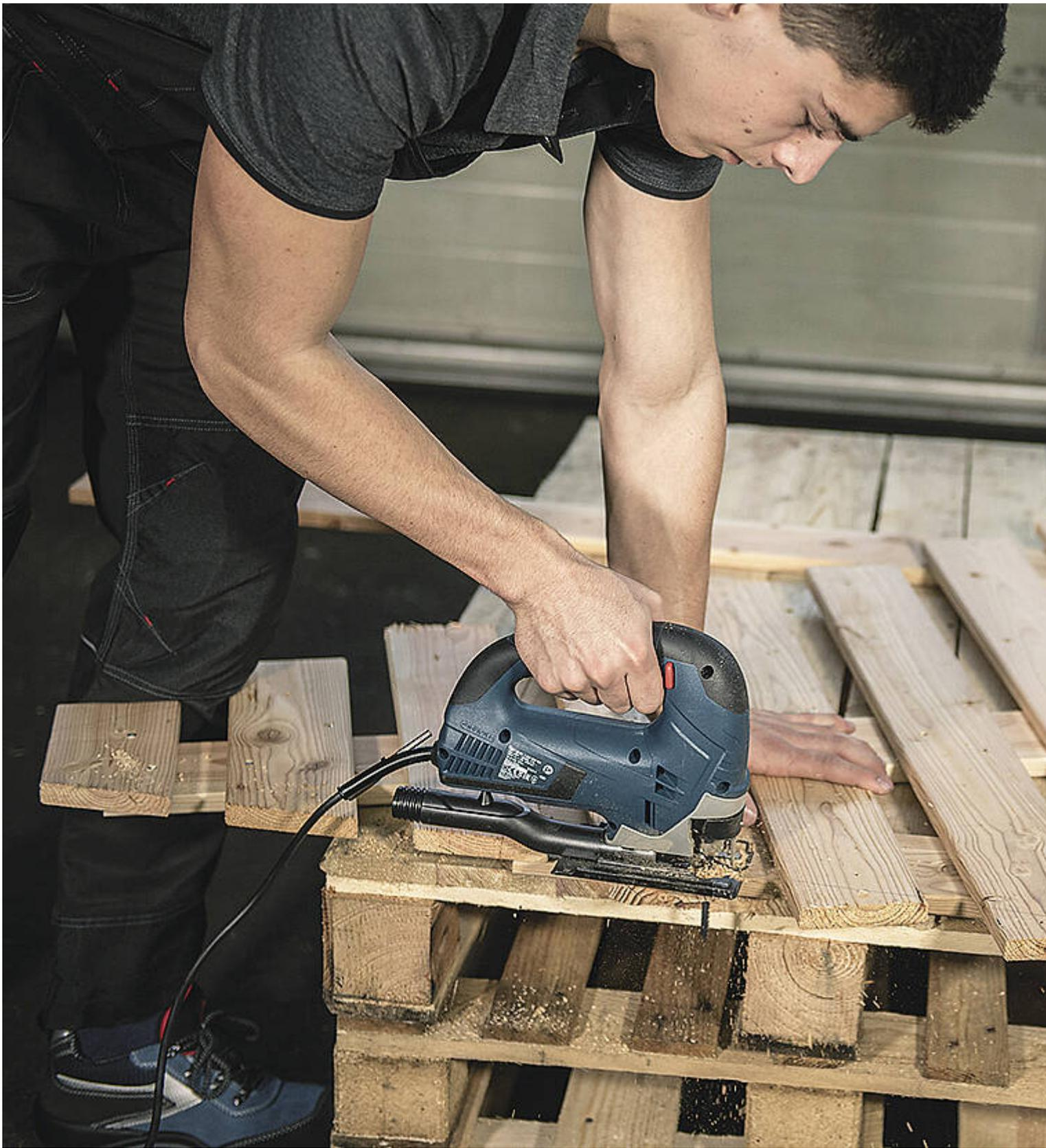
3: Mit einer Stichsäge die Latten entsprechend der eingezeichneten Linie auf beiden Seiten absägen.
