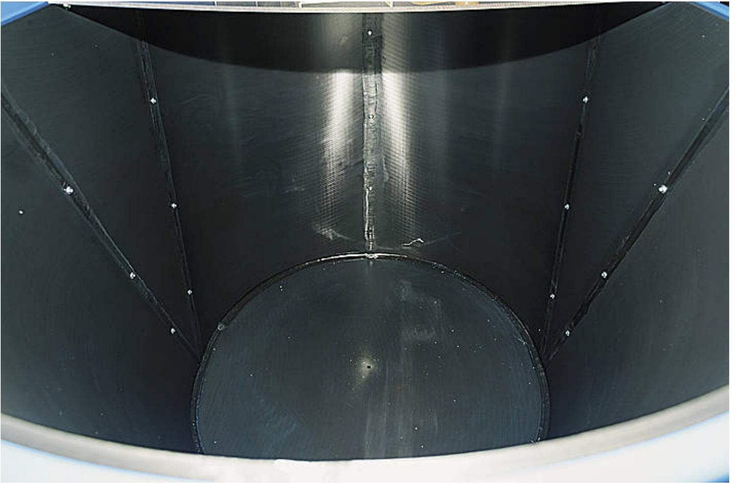
Da Robalon säurebeständig ist und nichts anhaftet, eignet es sich gut für Behälter und Mischschnecken in Geräten für die Tierfütterung.
