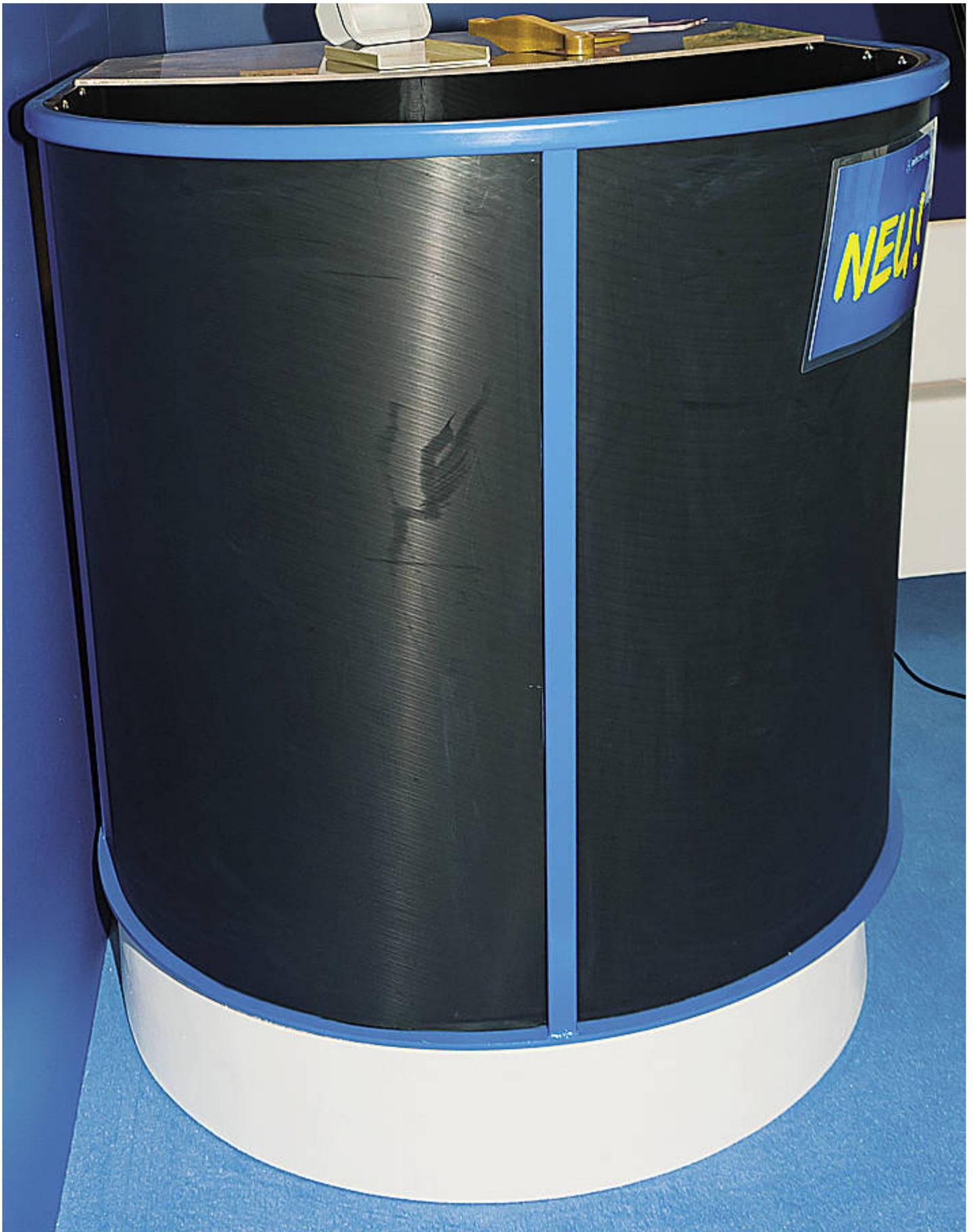
Behälter aus Sinterkunststoff verringern das Gewicht von Fütterungsrobotern erheblich.
