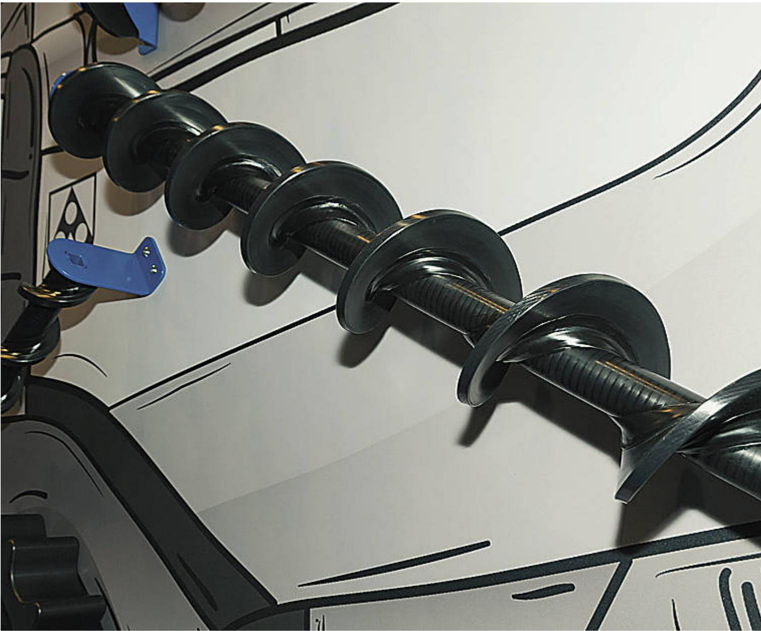
Merkmale von Förderschnecken aus hochfestem Sinterkunststoff sind geringes Gewicht und gute Gleitfähigkeit.
