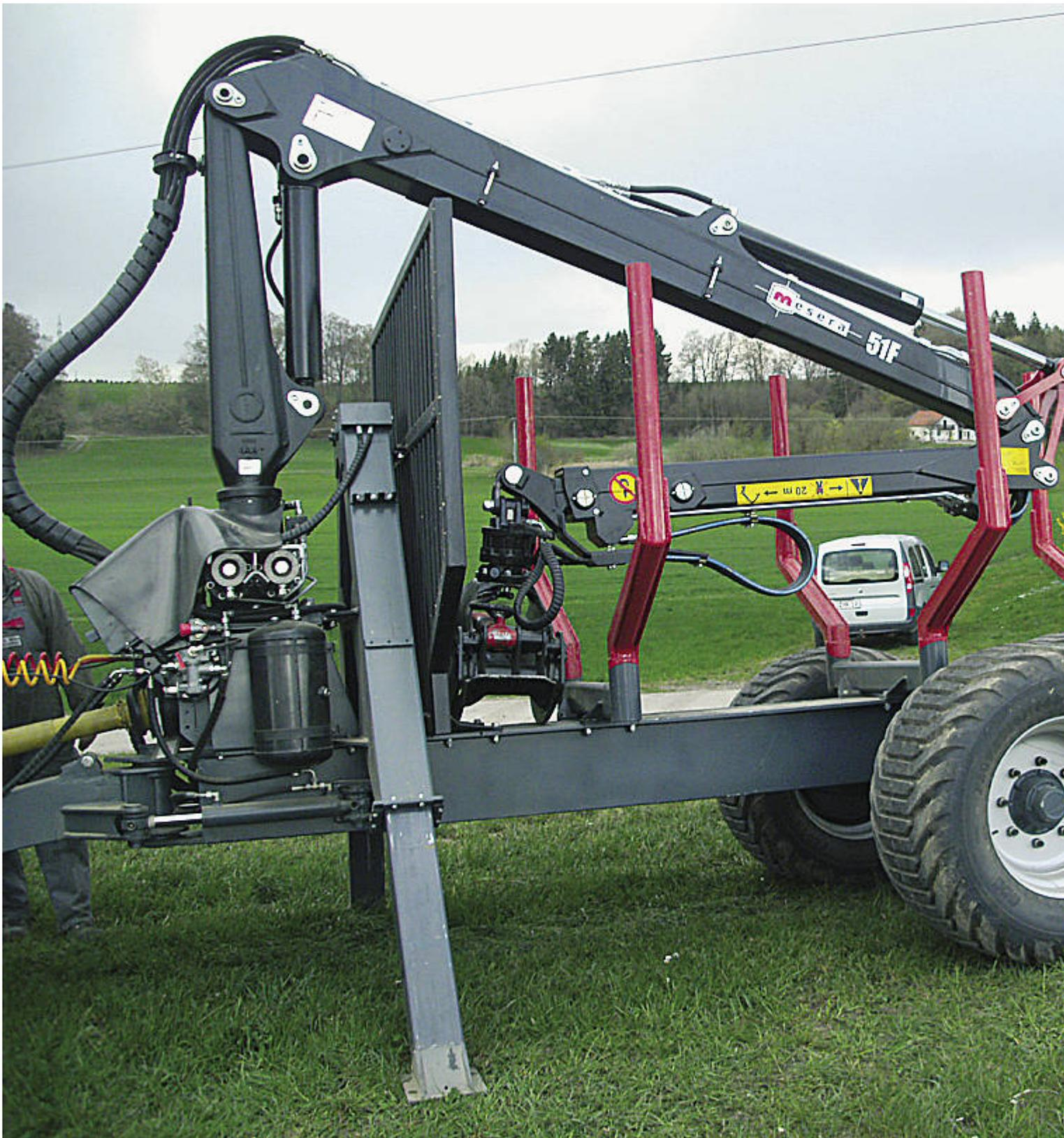
Meindl baute für Kunden verschiedene Rückwägen, u.a. mit elektronisch gesteuertem Hydrostat-Antrieb.
