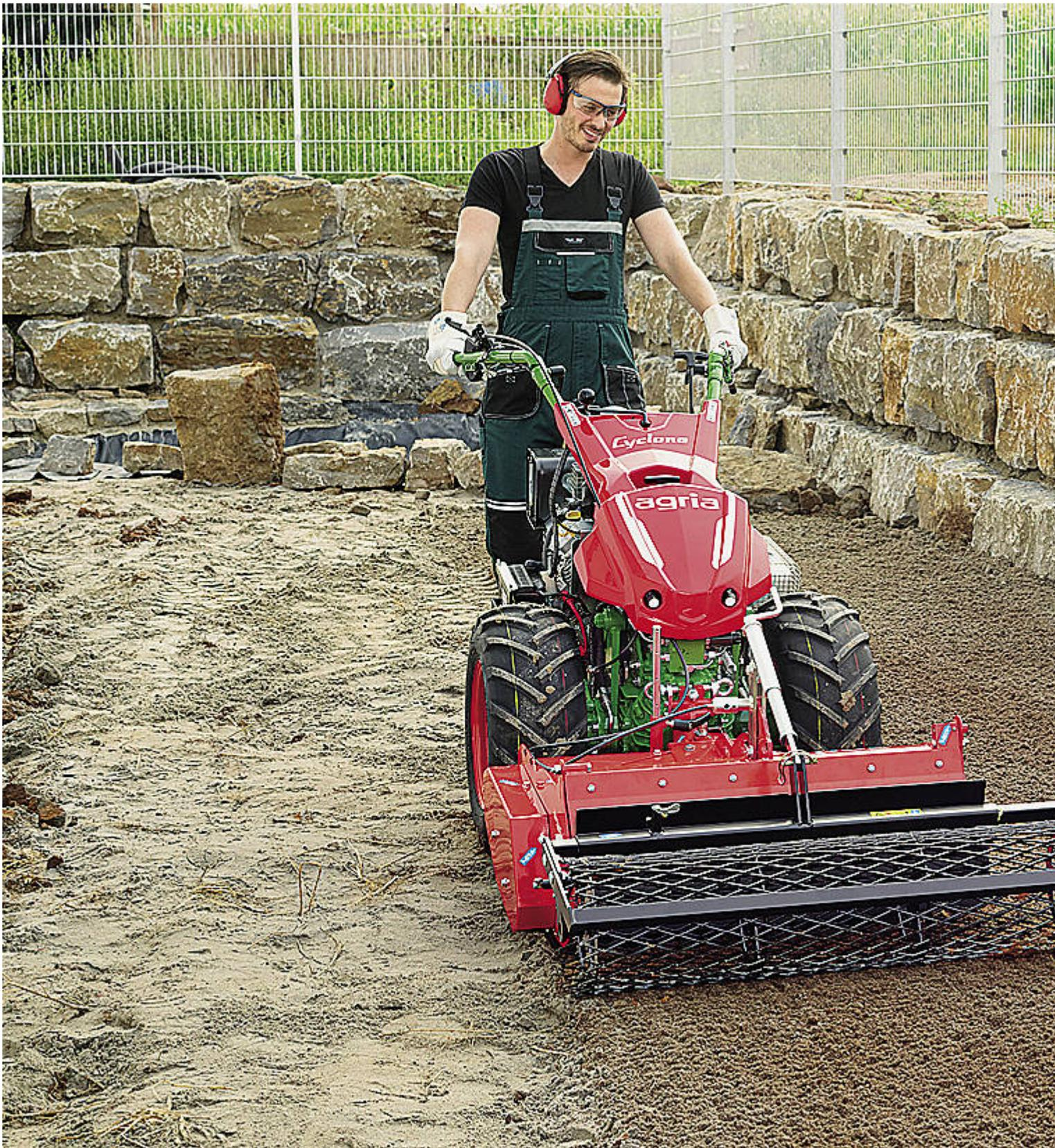
Bei den Agria-Werken werden multifunktionale Geräteträger wie der 5900 Cyclone (hier mit Umkehrfräse) nachgefragt.
