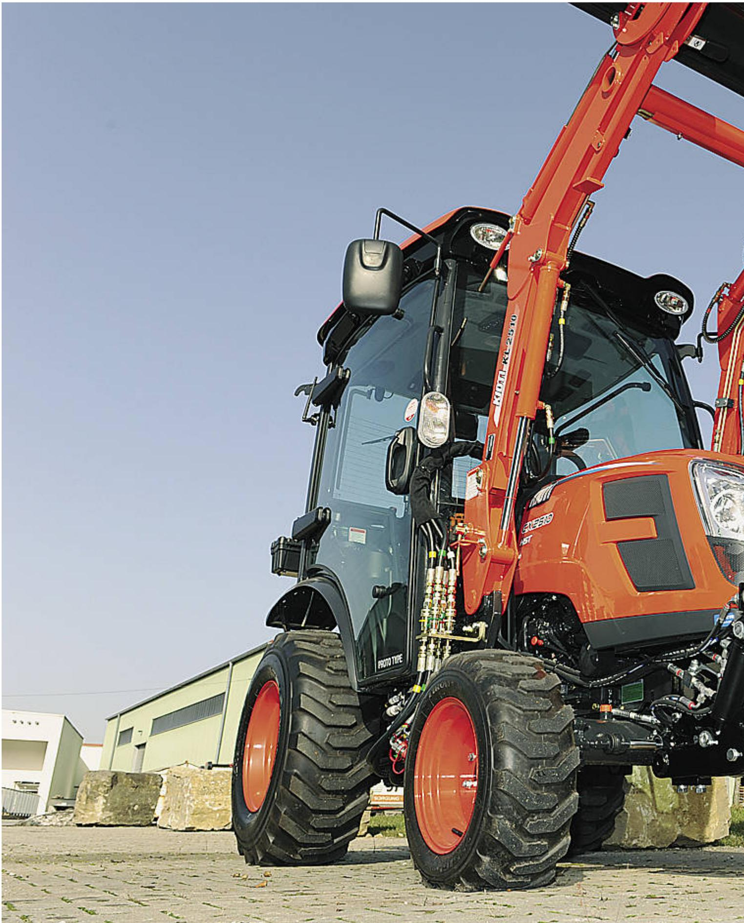
Der Kioti CX2510CH mit Frontzapfwelle und Lader ist neu im Programm und zielt auf den gewerblichen Einsatz.
