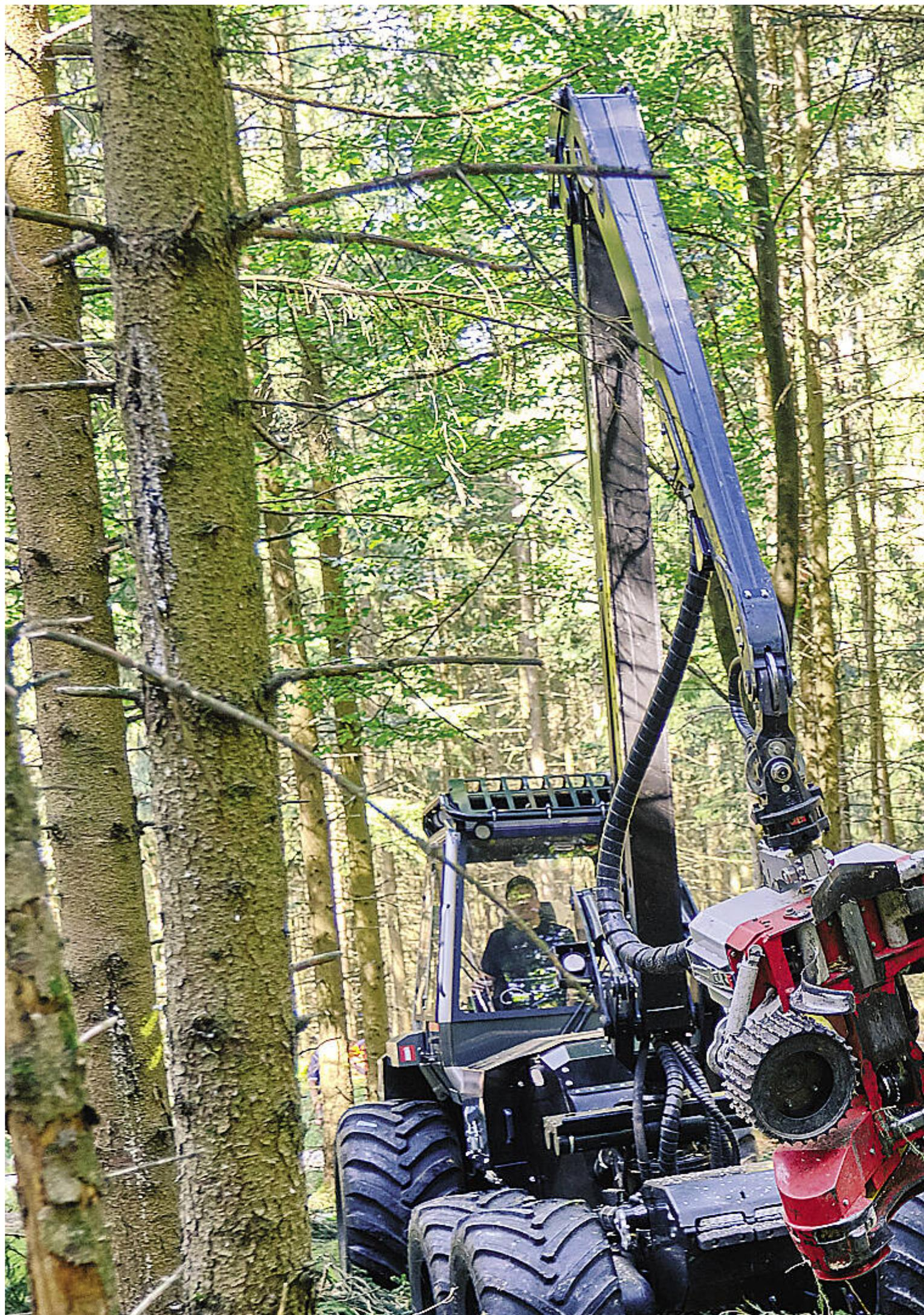
Das LogMax-Aggregat fällt maximal 42 cm, mit 412 kg passt es gut zum kleinen Kran.
