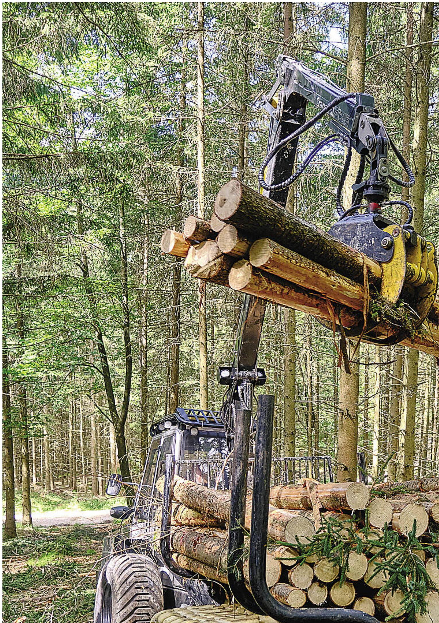
Durch Kunststoffbänder auf der Boogieachse läuft der Forwarder schonender, darunter sind 500er Reifen montiert. Am Vorderwagen sind auch 600er oder 700er möglich.
