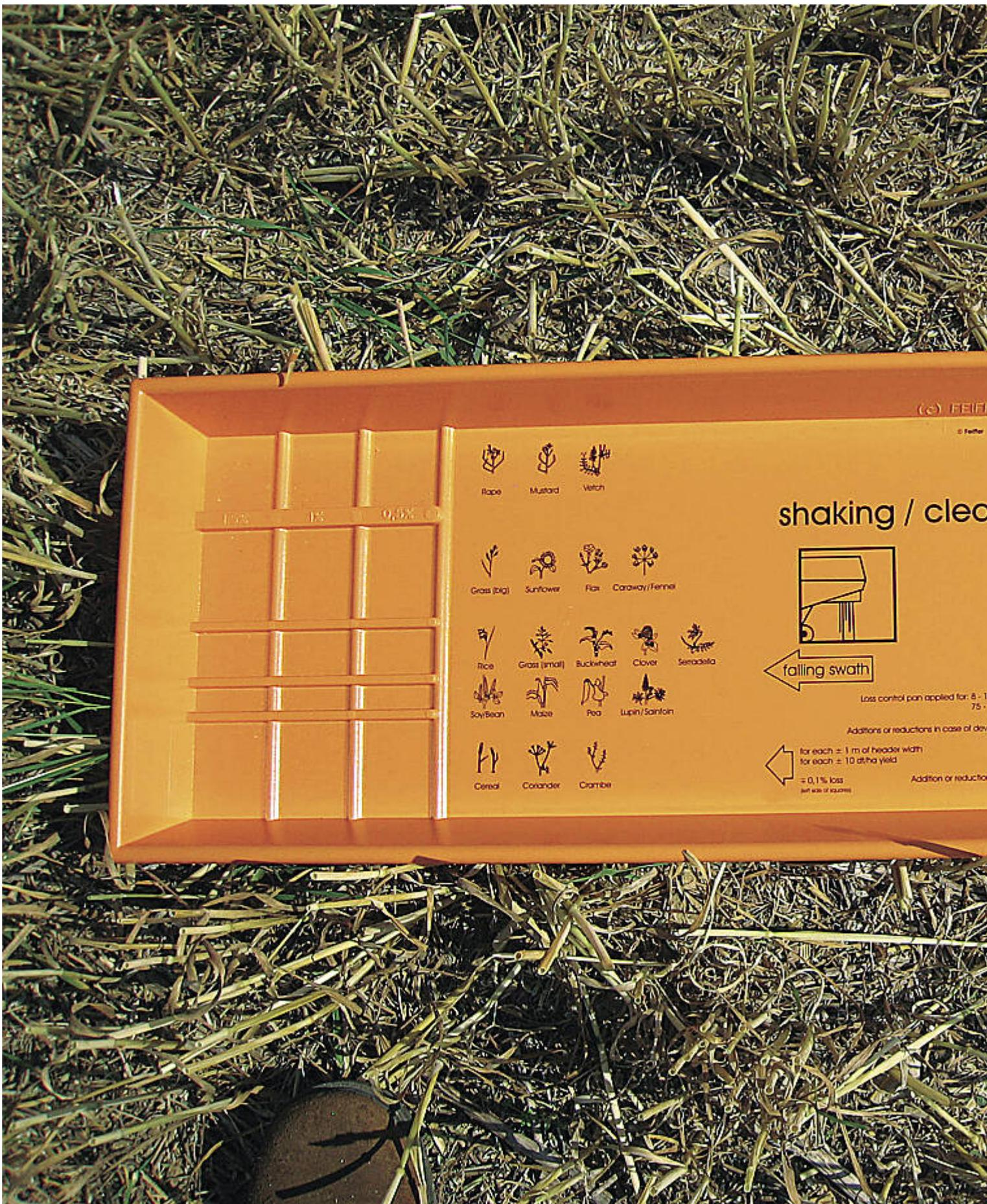
Ein praktisches Verlustmessinstrument ist die Feiffersche Verlustprüfschale. Neuerdings wird die Verlustbestimmung durch eine
