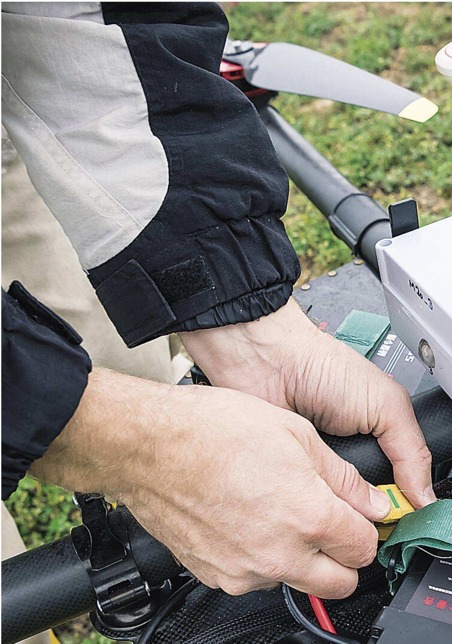
Nach 12 bis 15 Minuten müssen die aufgebrauchten Akkus der Drohne „Maja 20“ gegen aufgeladene ausgetauscht werden.
