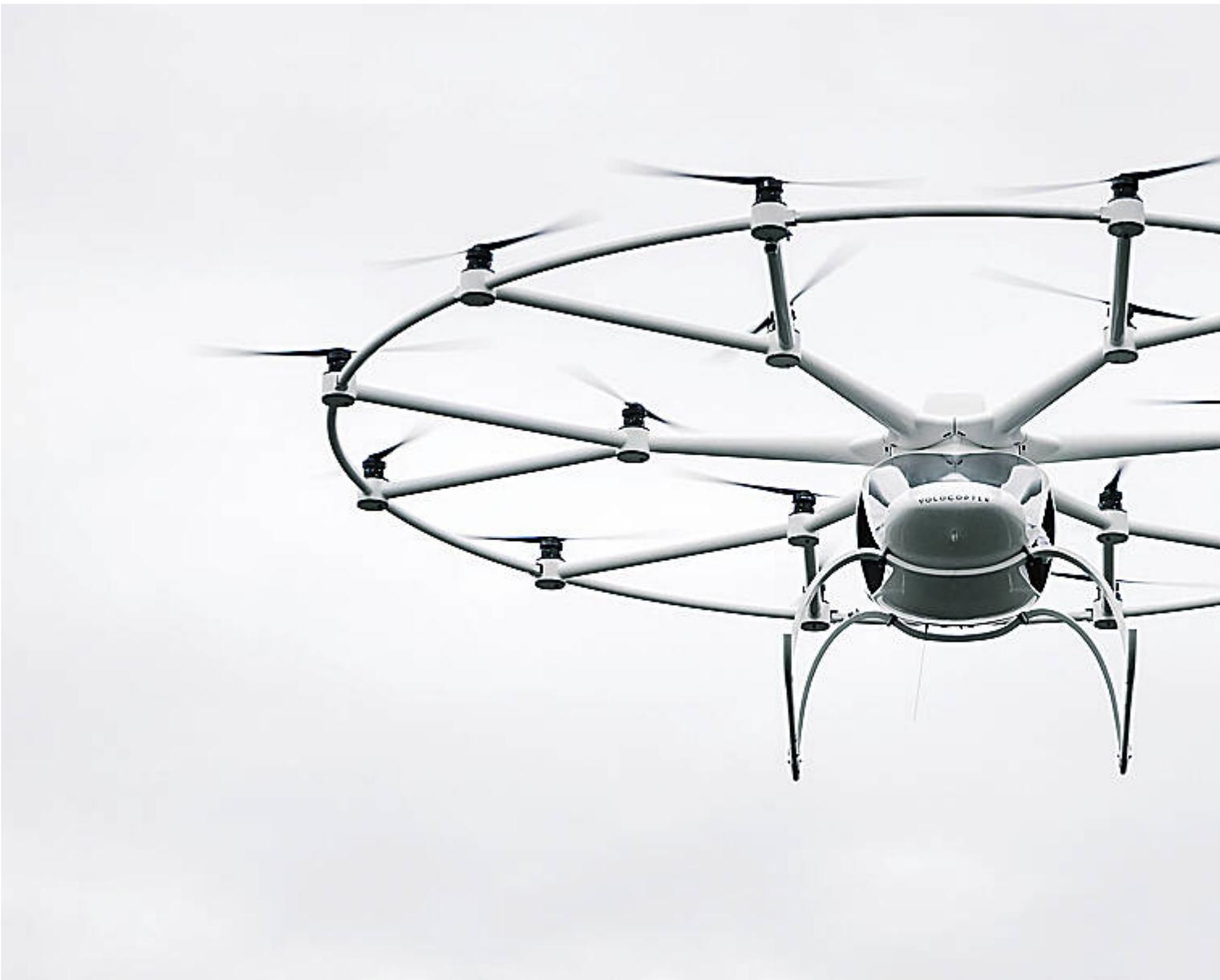
Der elektrisch angetriebene Volocopter VC200 des Drohnenherstellers e-Volo in Karlsruhe kann 160 kg fast eine halbe Stunde in
