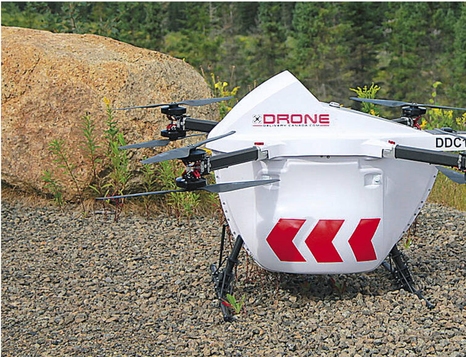
Das Modell Flyte des Herstellers Drone Delivery Canada transportiert 15 kg Nutzlast über eine Entfernung von bis zu 60 km und
