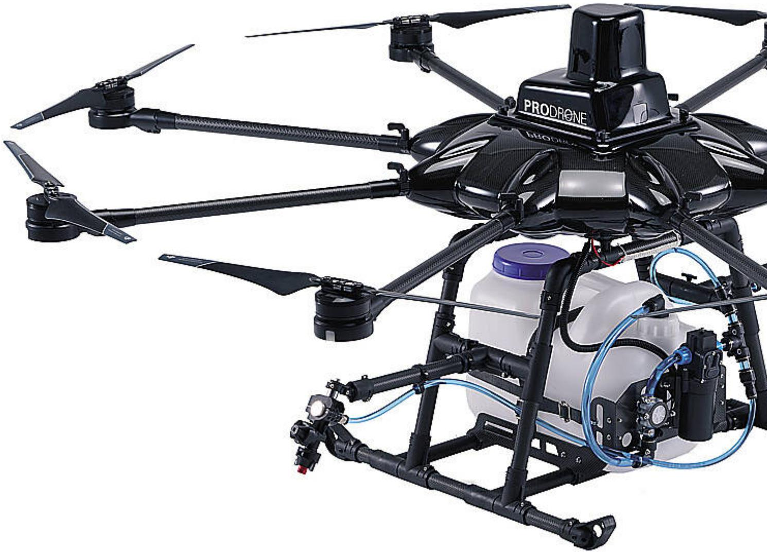
Die Agrardrohne SkymatiX X-F1 vom Hersteller Prodrone mit einem Spritzgerät und 10-Liter-Tank ist für den Pflanzenschutz von
