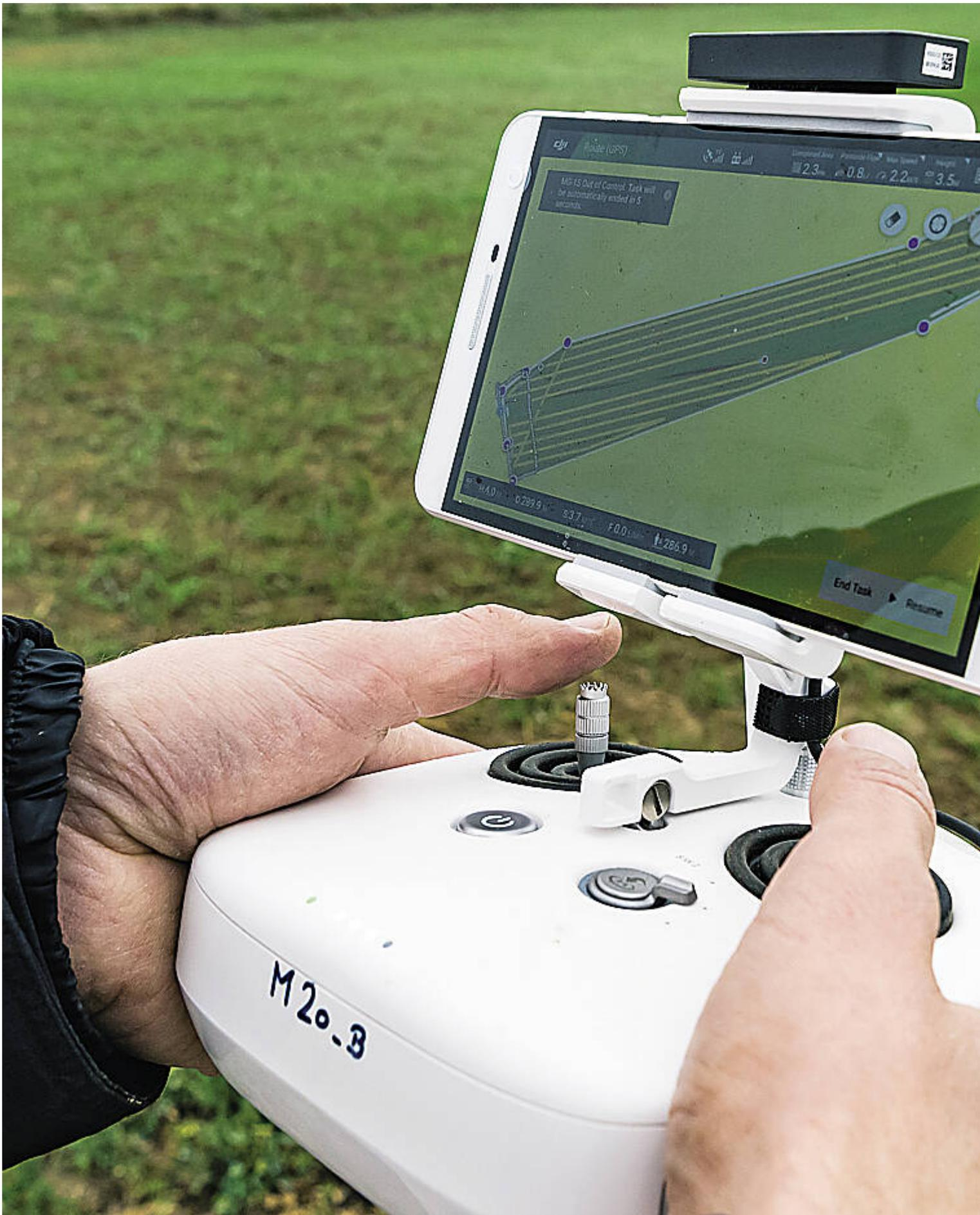
Auf dem Display der Steuerungseinheit sind die vorher berechneten Flugbahnen über dem Feld und die aktuellen Lagekoordinaten
