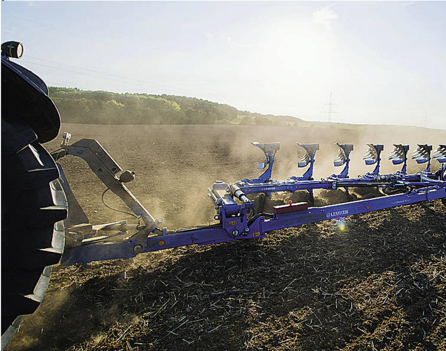
Stark und wendig: Der neue Aufsatteldrehpflug Diamant 16.
