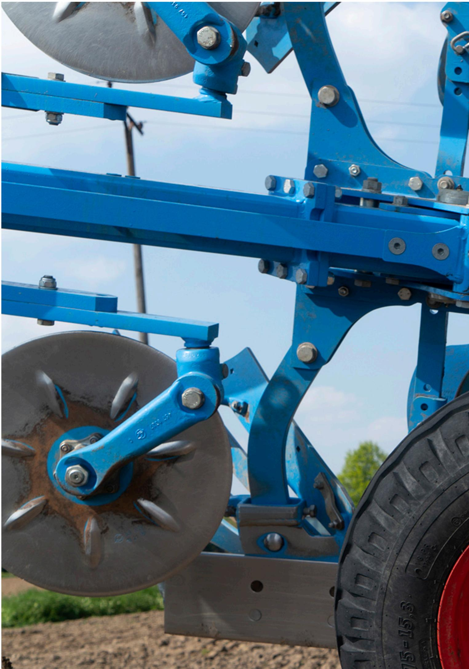
Pendelrad mit hydraulischer Dämpfung.
