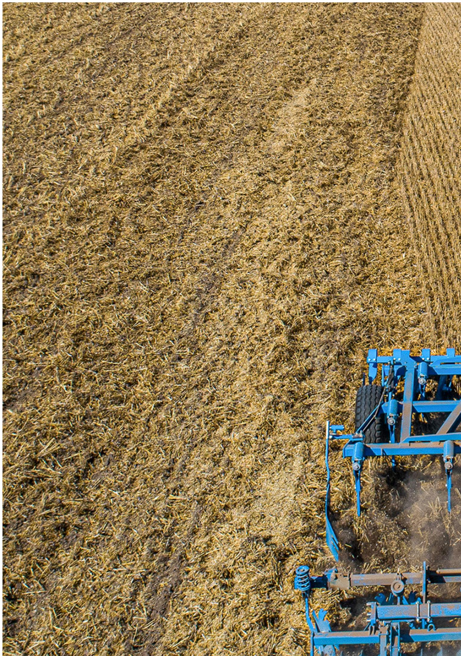
Die Zinken des neuen Karat 10 von Lemken sind jetzt symmetrisch zur Zugachse angeordnet.
