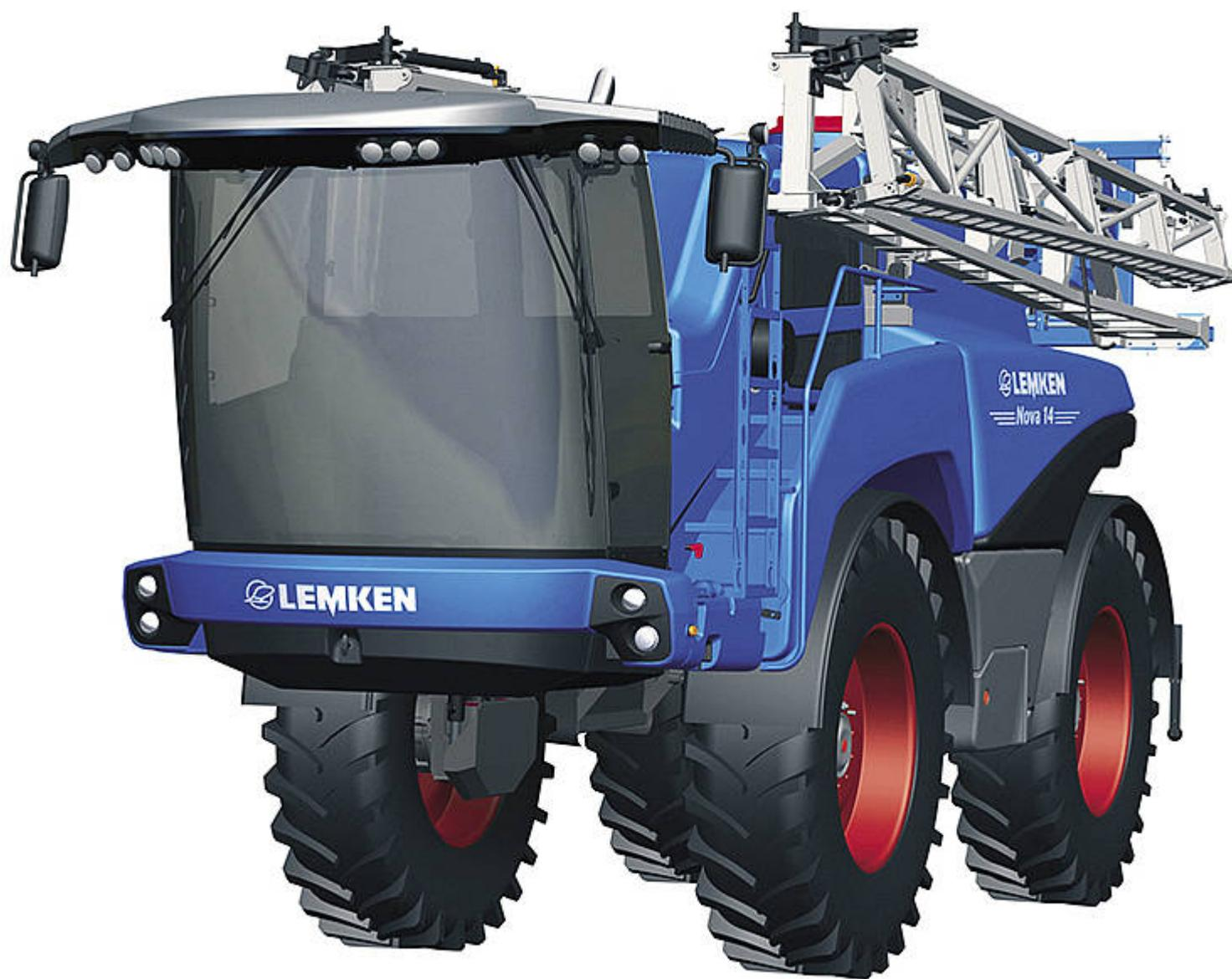
Die 2017 eingegangene strategische Partnerschaft mit einem Fahrwerkhersteller war der Startschuss für die Entwicklung einer selbstfahrenden Feldspritze. Jetzt stellt Lemken das fertige Produkt unter dem Namen Nova vor. Mit der geräumigen Kabine, einem vielseitig verstellbaren Fahrwerk und der neuen automatischen Gestängeführung genügt der Selbstfahrer mit Tankvolumen von 4.800 und 7.200 Liter und Arbeitsbreiten von 24 bis 39 Meter besonders hohen Ansprüchen.
