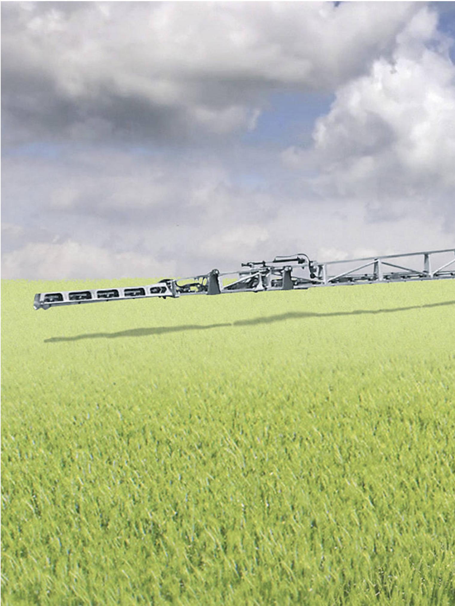
Der Selbstfahrer Nova hat Arbeitsbreiten von 24 bis 39 Meter.
