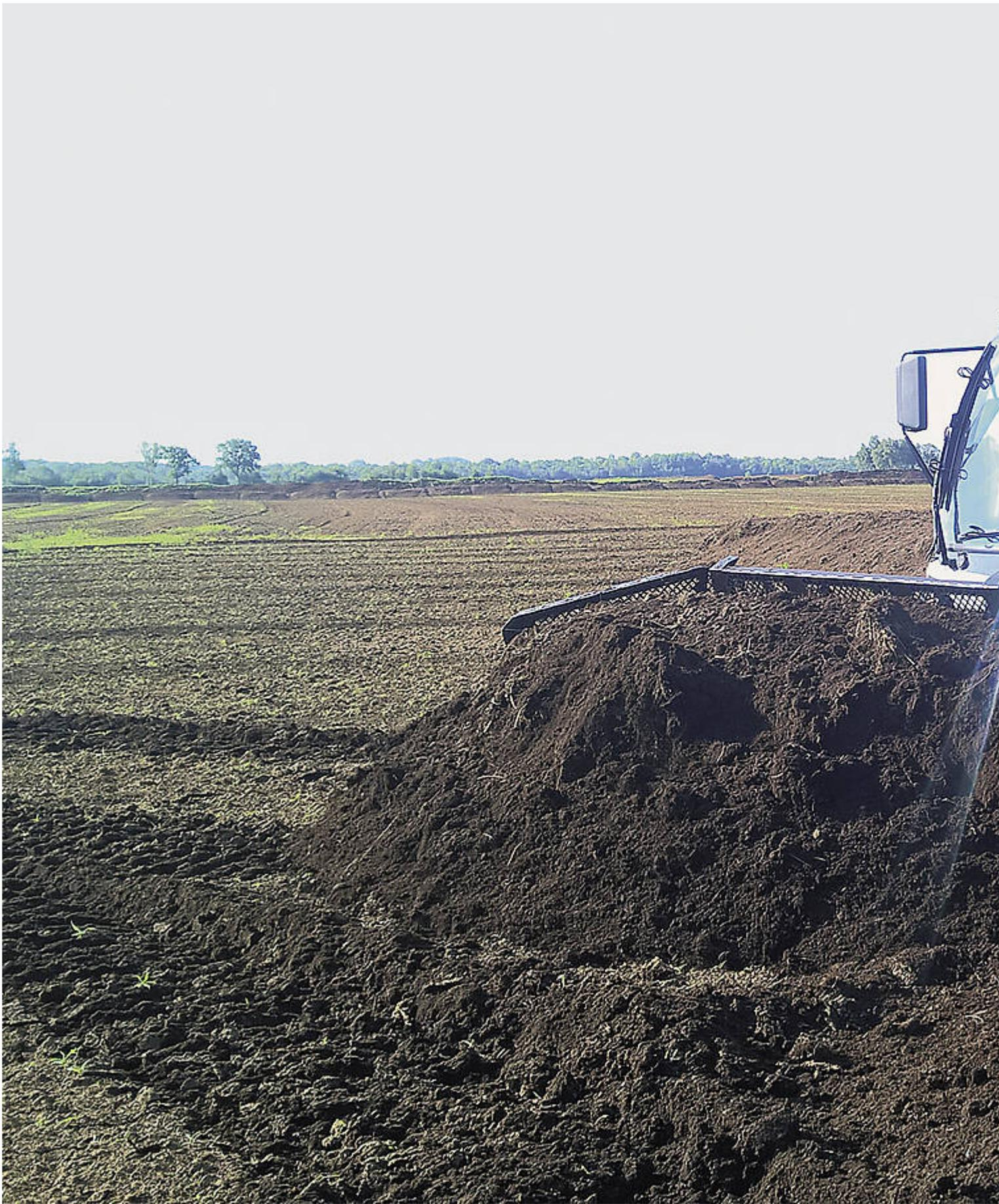
Erdarbeiten mit dem Schiebeschild an einer umgerüsteten Pistenraupe von Prinoth.
