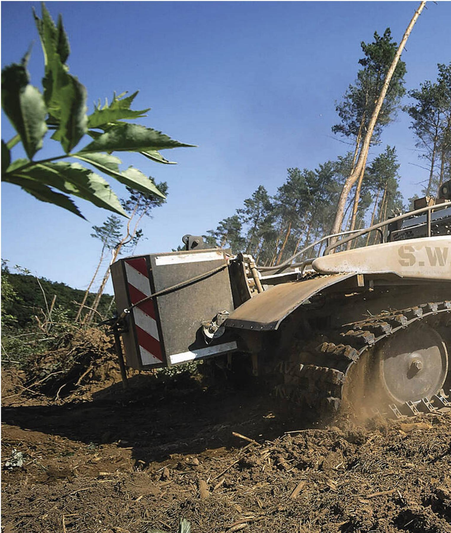
Das Raupenfahrwerk des 450 PS starken Pistenfahrzeugs von Prinoth sorgt auch in schwierigem Gelände für sicheren Stand.
