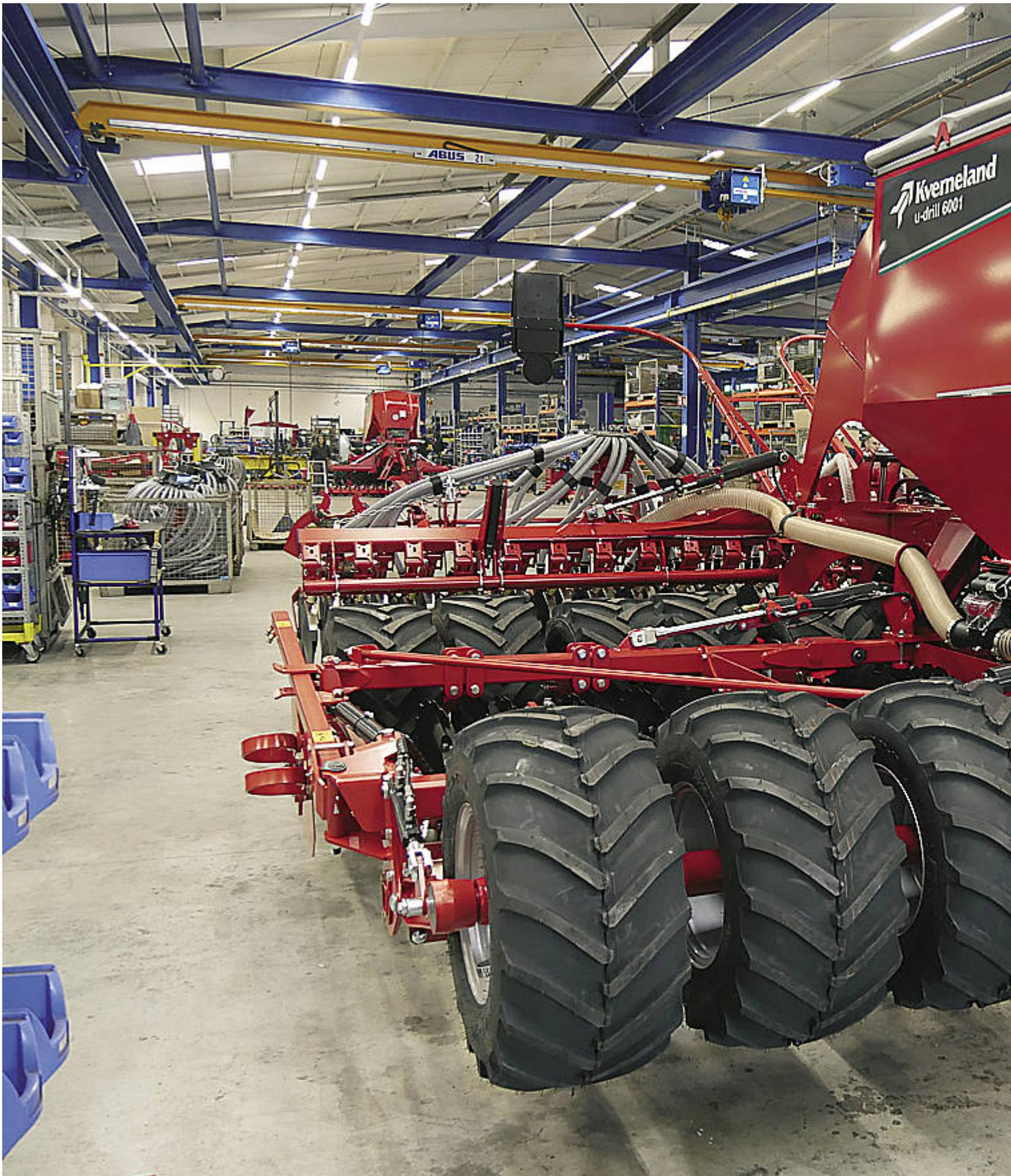
... jetzt sind nur die für das zu fertigende Einzelstück exakt erforderlichen Teile auf kleinen Trolleys bereitgestellt.
