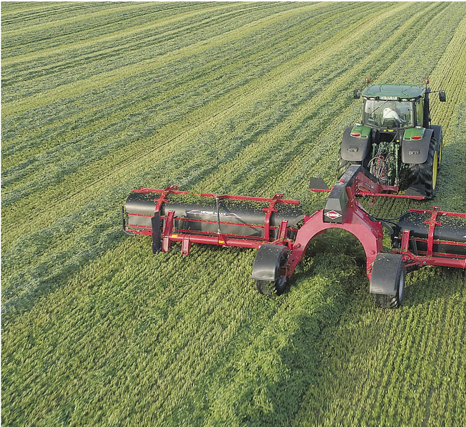
Der Merge Maxx 1090 erreicht bei mittiger Schwadablage eine Arbeitsbreite von 11 Metern. Kuhn
