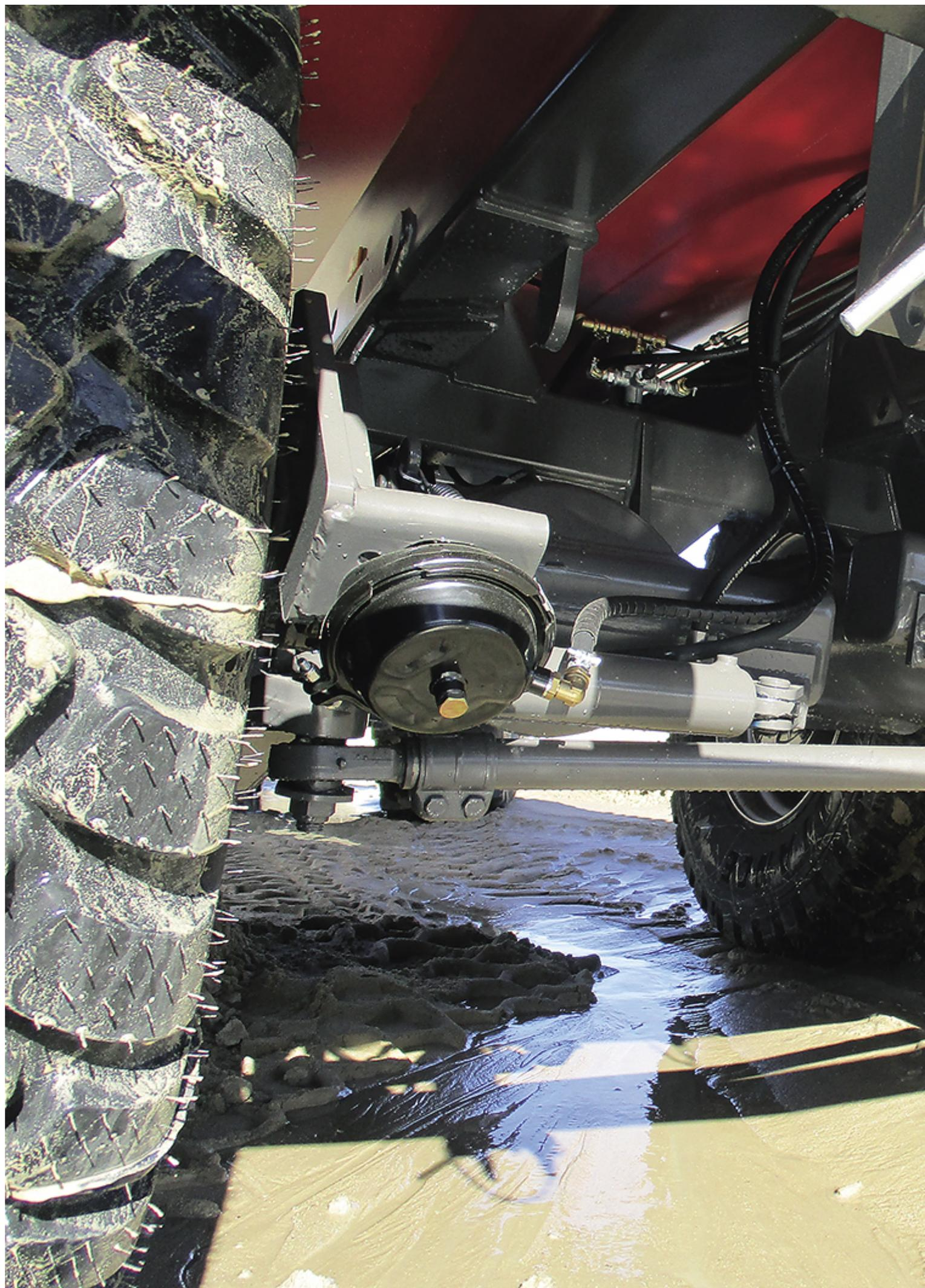
Erstmals hat der münsterländer Fahrzeugbauer Krampe ein Pendelaggregat mit einer zwangsgelenkten Achse ausgerüstet.
