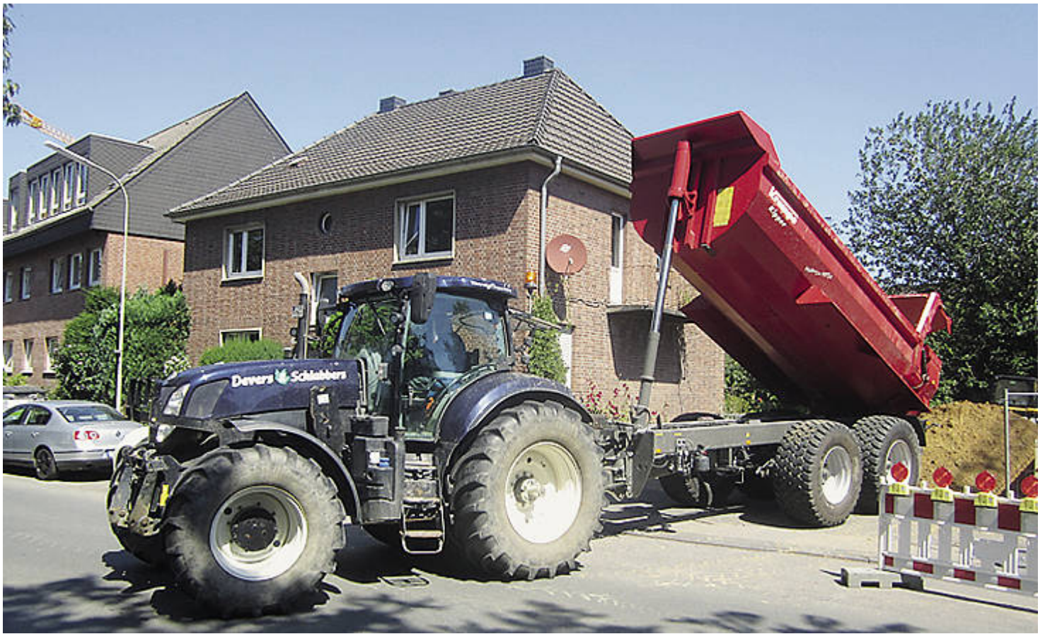
Das Pendelaggregat mit Lenkachse ist nicht nur robust, sondern ermöglicht auch einen engen Wendekreis. Hier beim Rückwärtsfahren in einer schmalen Baustelleneinfahrt.
