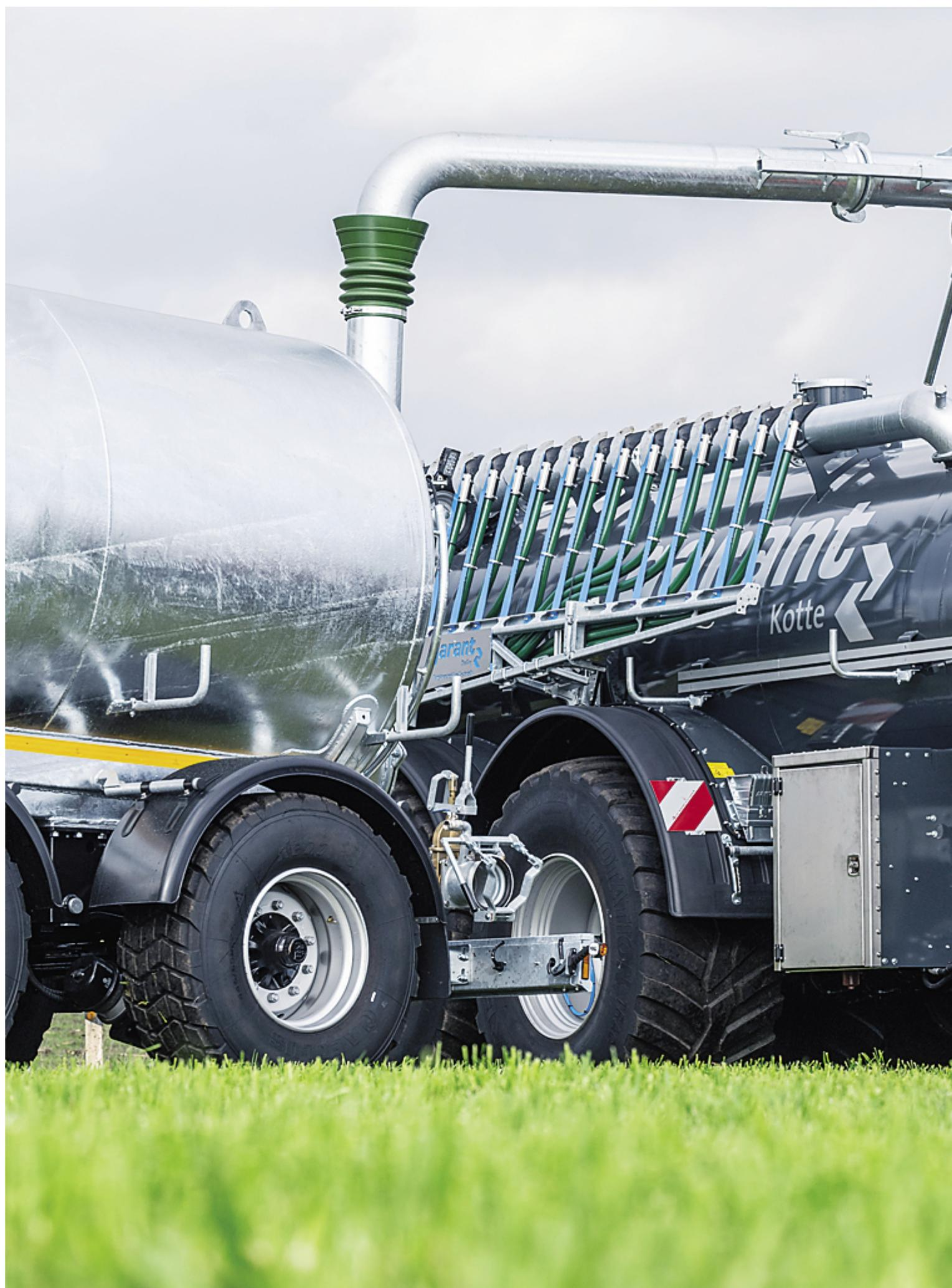
Mit dem Verlängerungsrohr des Saugrüssels Multi 3in1 ist eine Reichweite von drei Metern und eine Andockhöhe von vier Metern möglich.
