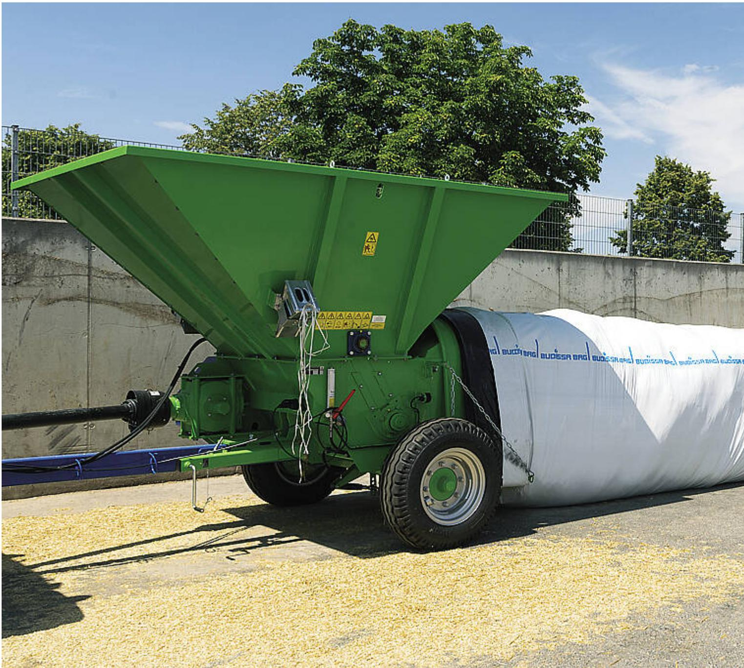
Durch die Lagerung im luftdichten Folienschlauch kann das Trennen des bei der Kompakternte eingefahrenen Gemisches Monokulturen erfolgen.
