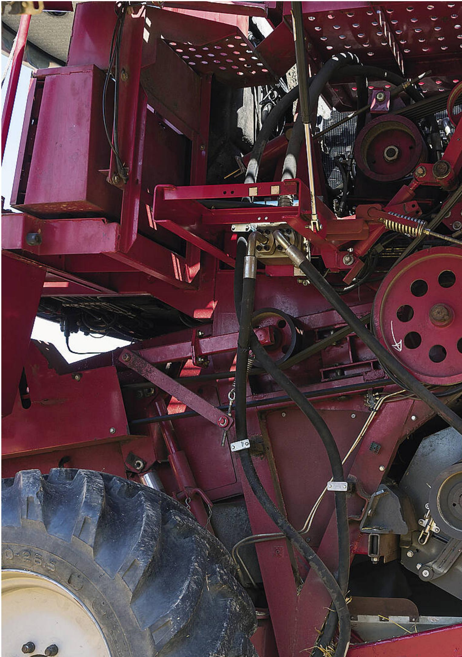
Der MDW-Mähdrescher Arcus mit seinem Schachtrötorsystem bot durch die Lage der Dreschroten direkt hinter dem Schneidwerk günstige Voraussetzungen für den Umbau zum Demonstrator für die Kompakternte.
